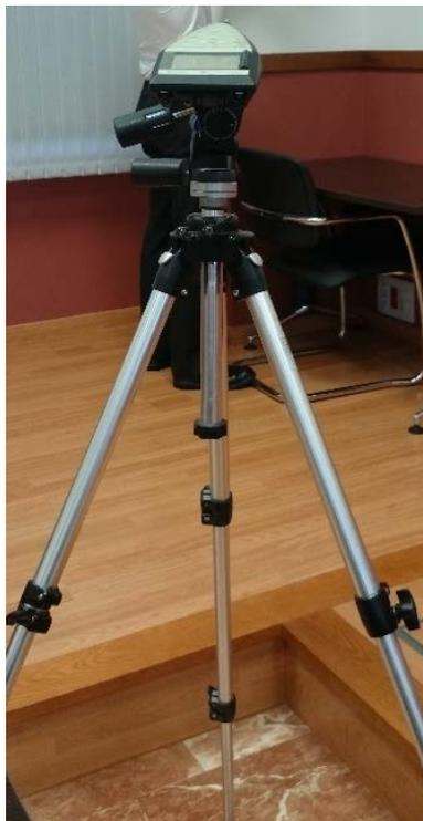
Figura 4-12. Sonómetro modelo 2260 de Brüel & Kjaer
