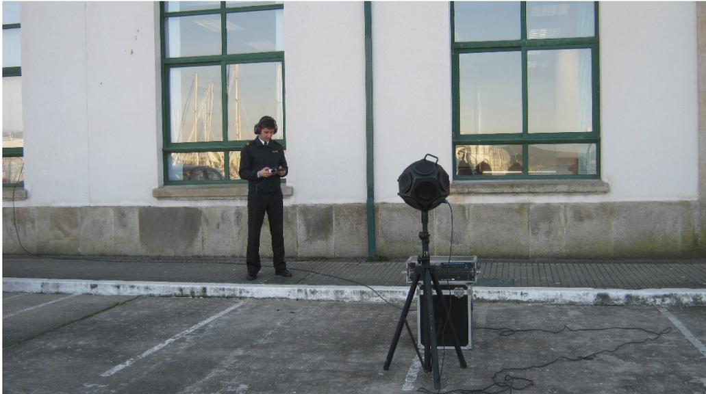
Figura 4-25. Medición del nivel de presión acústica  $L_{1,2m}$  (frente a la fachada)
