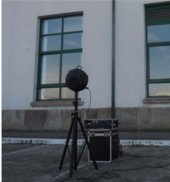
Figura 4-13. Fuente sonora omnidireccional modelo 4296 de Brüel & Kjaer
