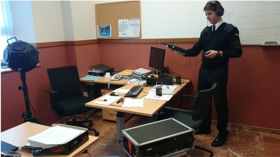
**Figura 4-18. Medición del nivel de presión acústica  $L_1$  (recinto emisor)**
