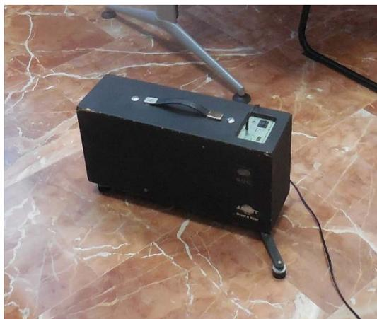
Figura 4-14. Máquina de impactos modelo 3207 de Brüel & Kjaer
