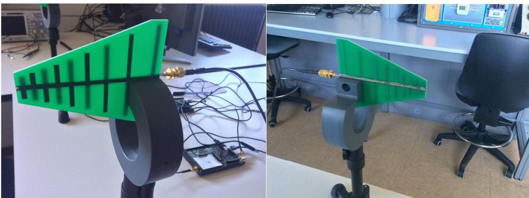
Figura 4-1 Antenas empleadas para la realización del GPR
