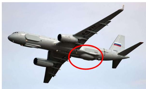
Figura 2-22 TU-214 equipado con georradar. Este avión fue desplegado en 2016 para hacer frente al *DAESH* en Siria [47]
