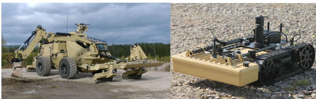
Figura 2-16 Vehículo C-IED PEROCC (izquierda) [40] y UGV con dispositivo AMULET (derecha) [41]
