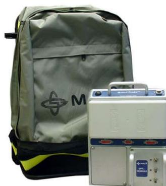
Figura 2-5 Unidad de control ProEx de la compañía Malå Geoscience [17]
