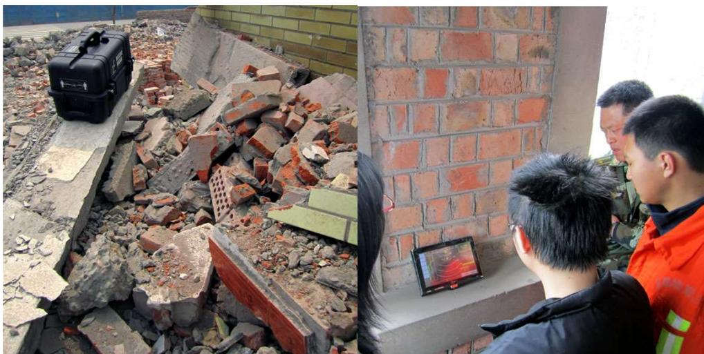
Figura 2-20 *GPR* de rescate ubicado en una zona catástrofica en Chengdu (China) y operadores de rescate en la misma provincia observando la recepción de datos del *GPR* (izquierda y derecha, respectivamente) [39]
