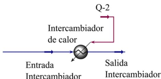
Figura 4-3 Intercambiador de calor previo al reactor
