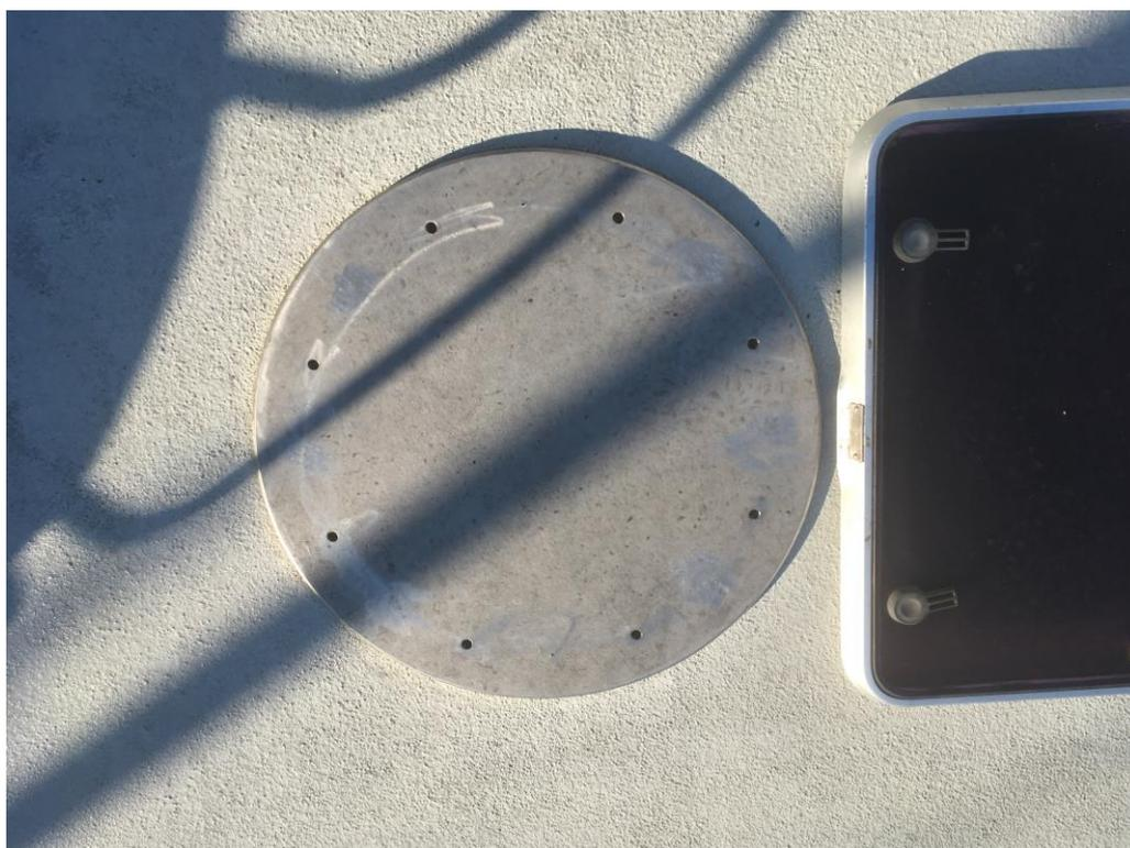
**Figura 3-2 Base de fijación en las lanchas de instrucción.**
