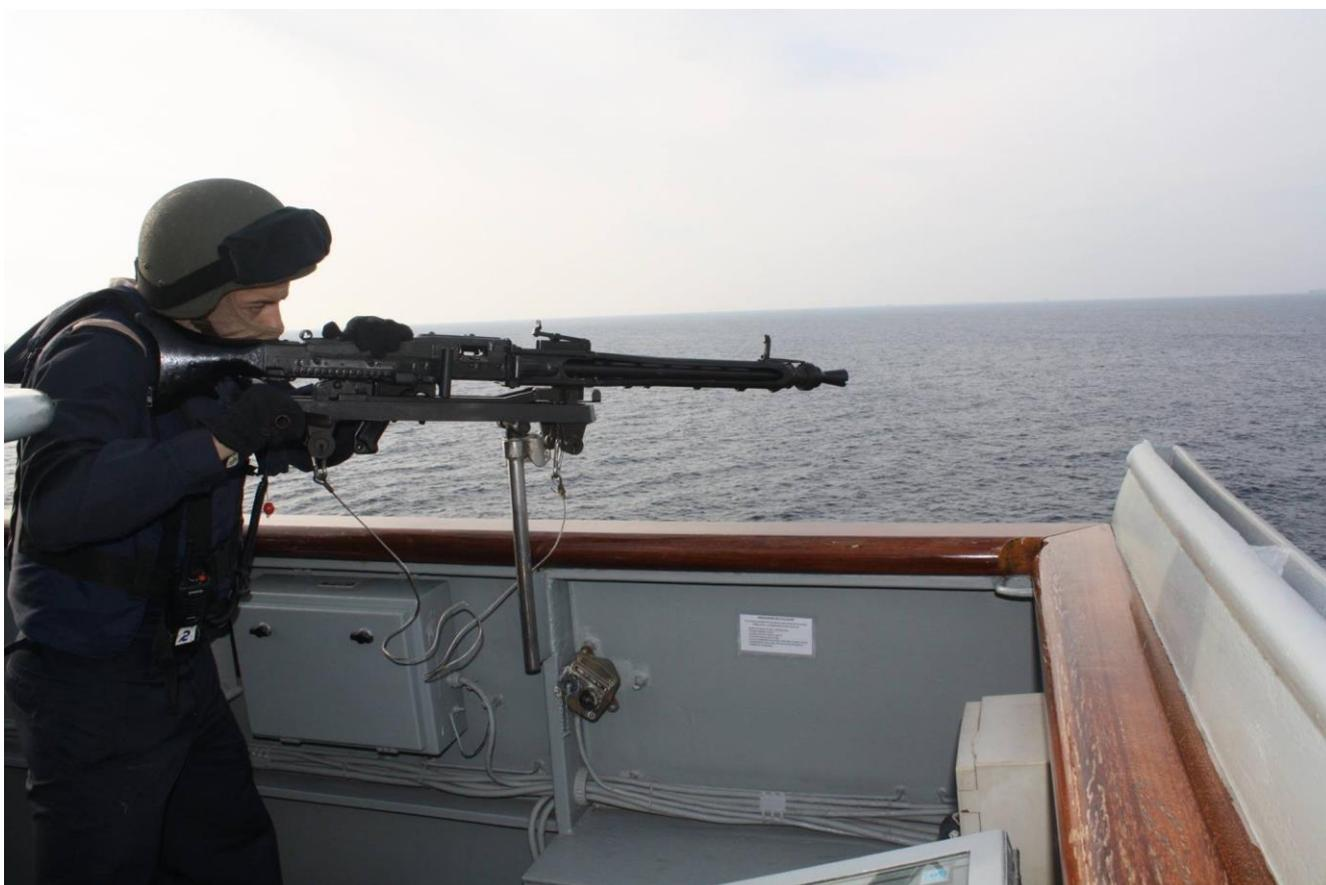
**Figura 2-8 Afuste para ametralladora media y ligera.**
