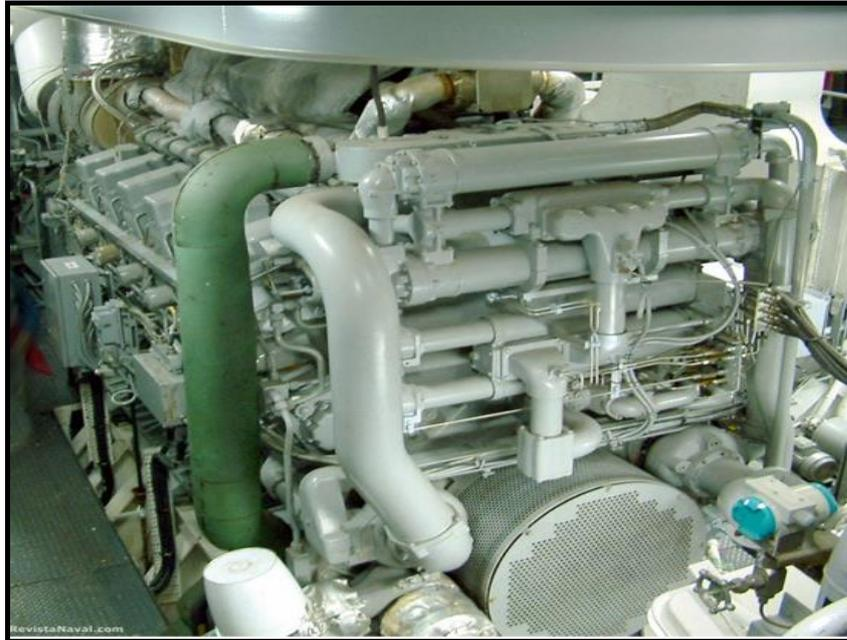
**Figura 6-8 Motor Diésel Bravo 16 V de la F-105**
