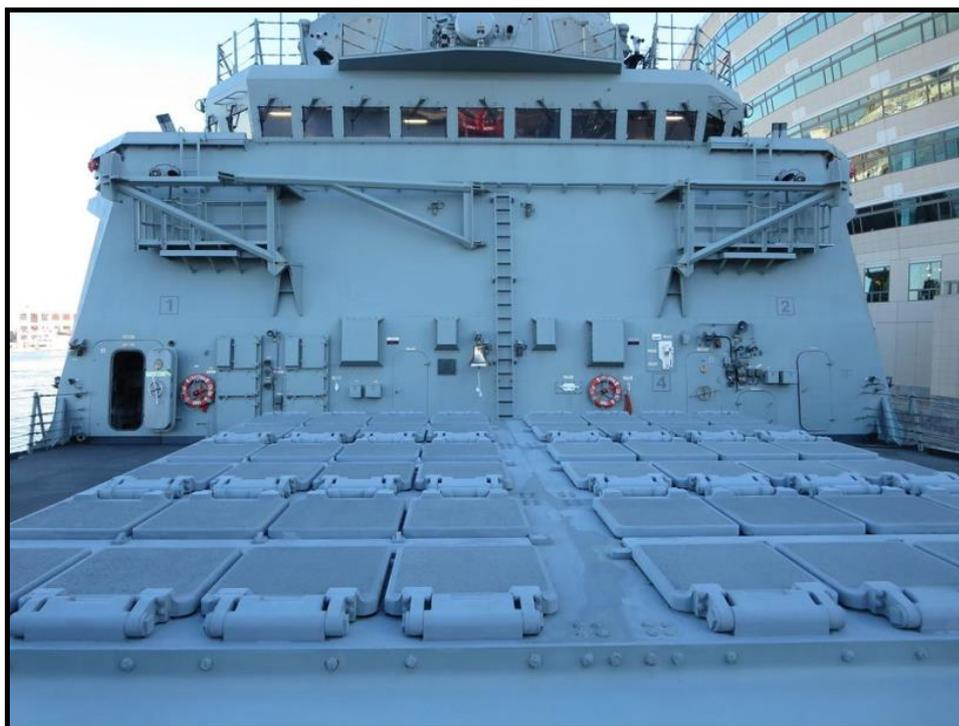
**Figura 6-14 Sistema de lanzamiento vertical (VLS), MK-41 [35].**
