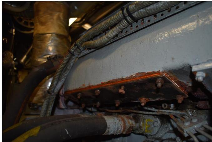
**Figura 3-11 Corrosión en la placa del enfriador de agua dulce**
