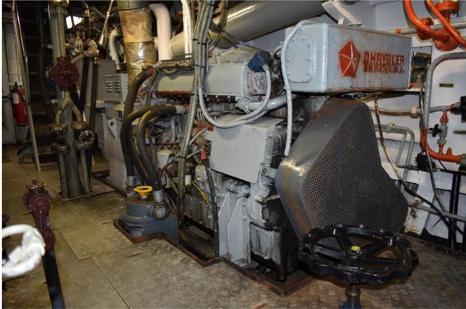
**Figura 3-4 Motor auxiliar de la banda de estribor**
