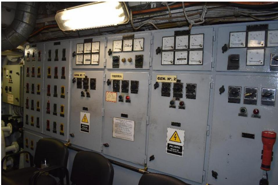
Figura 3-3 Cuadro principal de distribución en la cámara de máquinas
