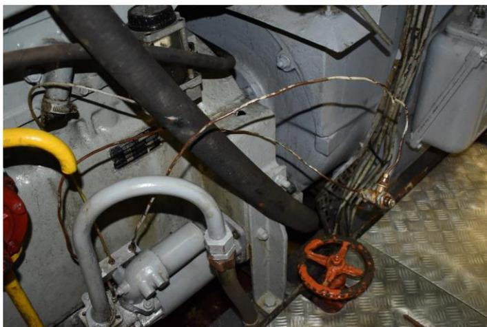
**Figura 3-13 Reparación temporal del sistema de arranque neumático del auxiliar de babor**
