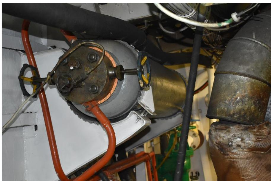
**Figura 3-5 Botella auxiliar del servicio neumático del buque**
