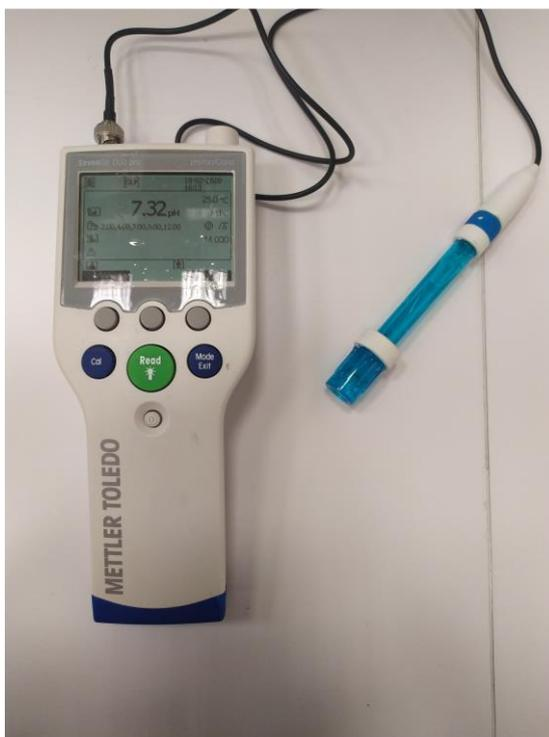
Figura 3-6: pH-metro 'Toledo' usado durante la experimentación.
