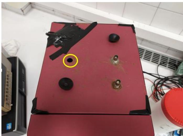
**Figura 3-4: Orificio para la toma de muestras**
