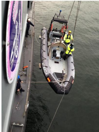
**Figura 5-8 Maniobra de arriado de embarcaciones con gancho CAR-35. (Fuente:[22])**
