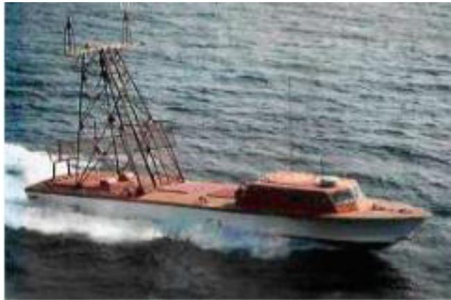
**Figura 2-4 QST-35/35A SEPTAR, USV usado como objetivo. (Fuente: [4])**
