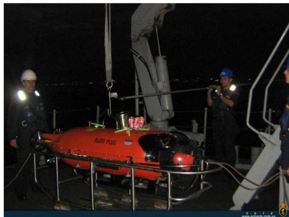
**Figura 2-2** Maniobra arriado Pluto Plus, UUV de la Armada Española. (Fuente: [3])
