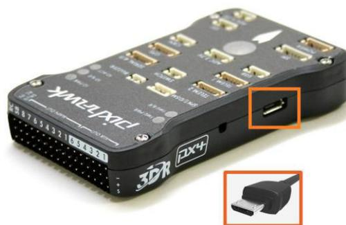
Figura 7-13 Conexión del hardware autopiloto mediante mini-USB. (Fuente: [31])
