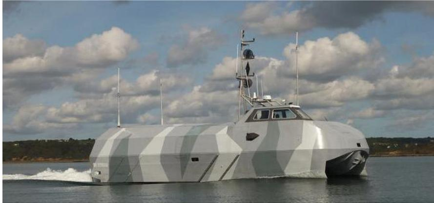
**Figura 2-7 USV del proyecto “Espadon”. (Fuente: [8])**
