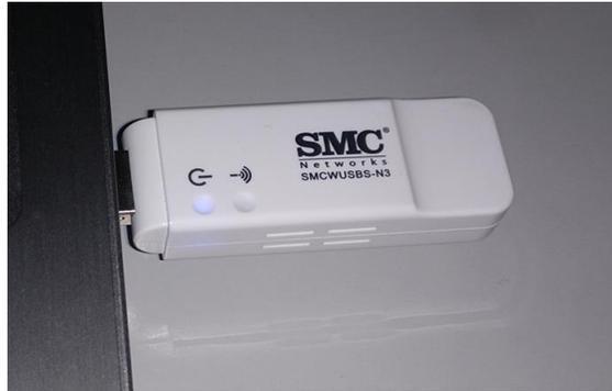
Figura 4-17 Adaptador *wireless* USB *SMCWUSBS-N3*
