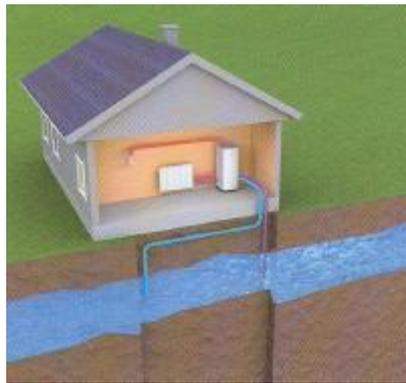
Figura 2-9 Circuito de captación abierto ( [13])
