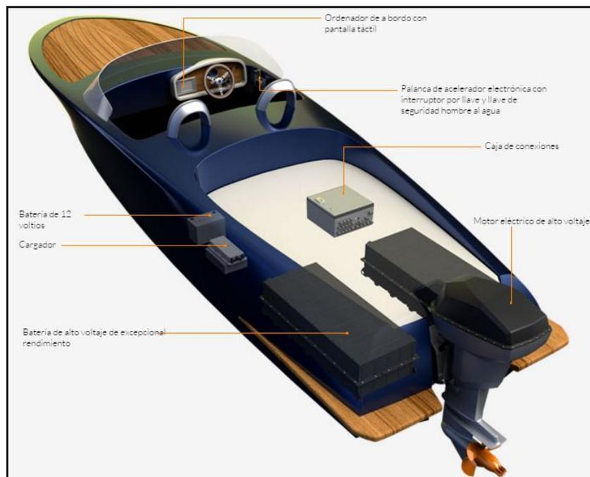
Figura 3-3 Distribución elementos propulsión eléctrica Torqeedo [6]
