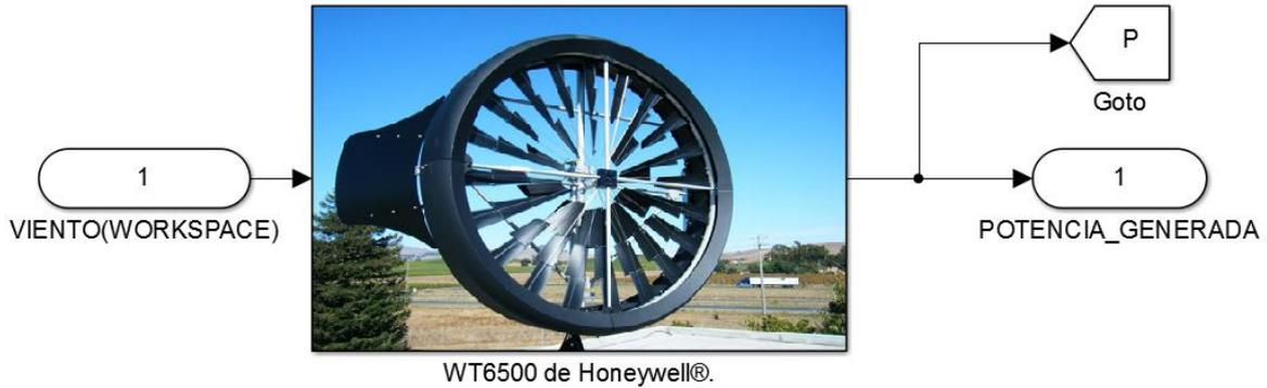
**Figura 20: Diagrama de la Turbina WT6500 de Honeywell® en SIMULINK®.**
