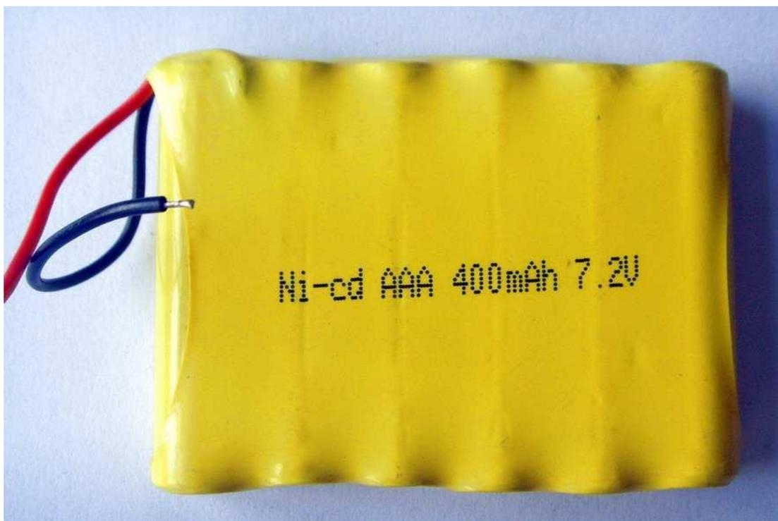
**Figura 8: Batería de NiCd.**
