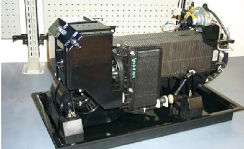
Figura 40: Pila de combustible Nexa™ 1200W de la casa BALLARD ®.
