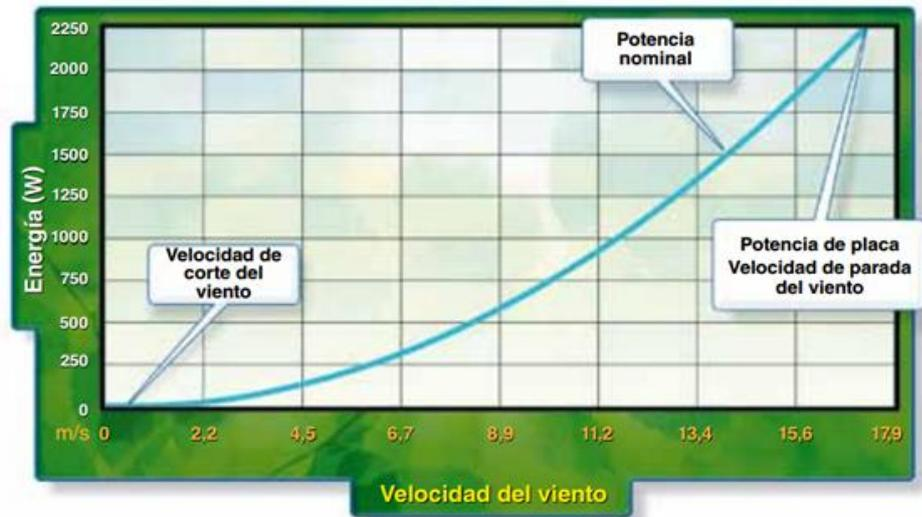
Figura 18: Gráfica relación viento/ potencia, ofrecida por Honeywell®.
