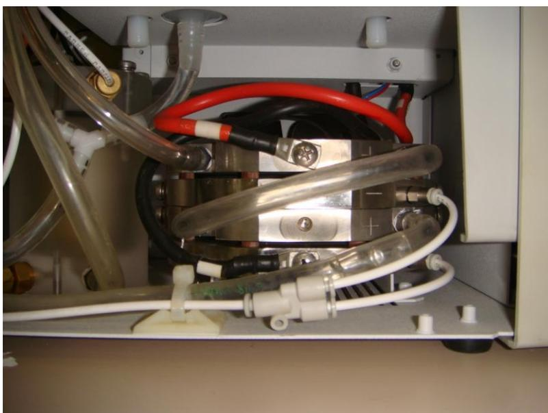
Figura 34: Interior del electrolizador NMH2-500.
