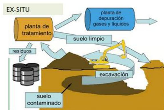
Figura 2.1 Tratamiento ex situ para descontaminar la tierra. [10]
