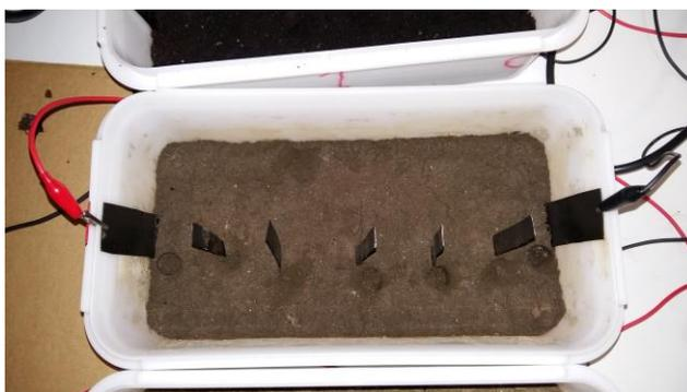
Figura 3.2 Disposición de las tiras de grafito sobre una de las muestras de tierra
