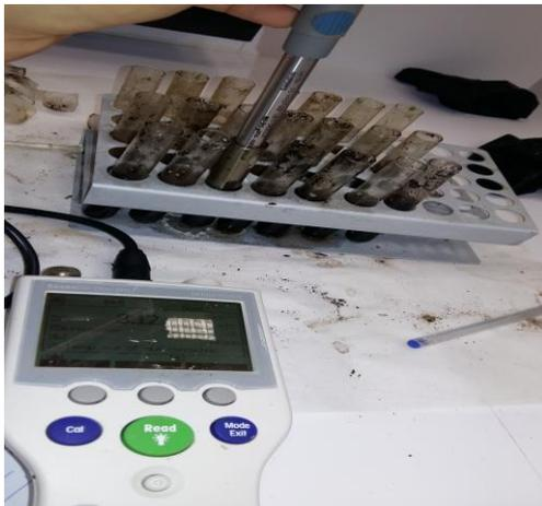
**Figura 3.4 Medición del pH aplicado a cada muestra**
