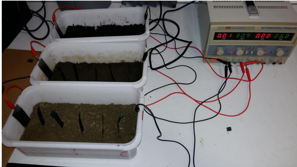
**Figura 3.5** Aplicación del voltaje sobre cada una de las muestras de tierra.
