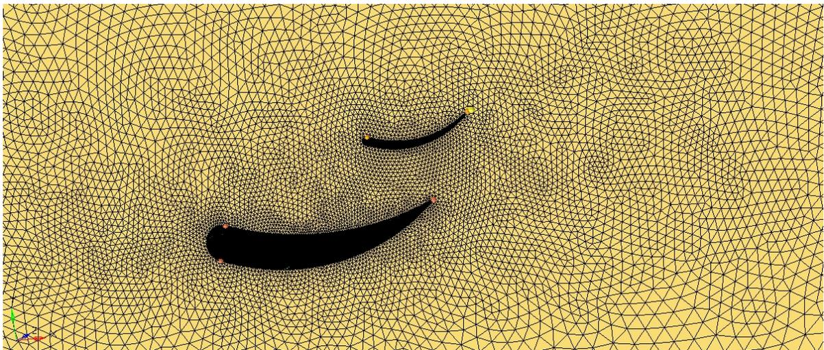
**Figura 3-2 Alerón mallado visto de perfil con factor de crecimiento. [Autoría propia]**
