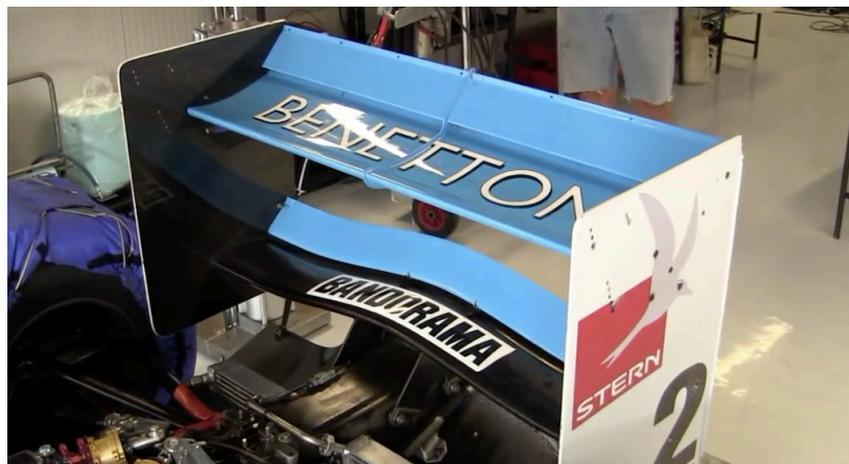
Figura 2-16 Alerón de doble plano del Benetton B197. [21]
