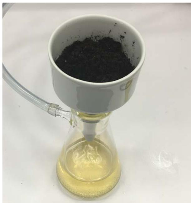
**Figura 12 Filtrado a vacío**
