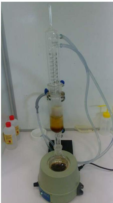
Figura 13 Extracción Soxhlet
