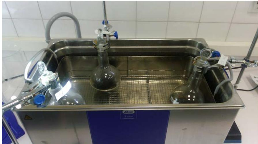
**Figura 11 Descontaminación en baño ultrasónico**
