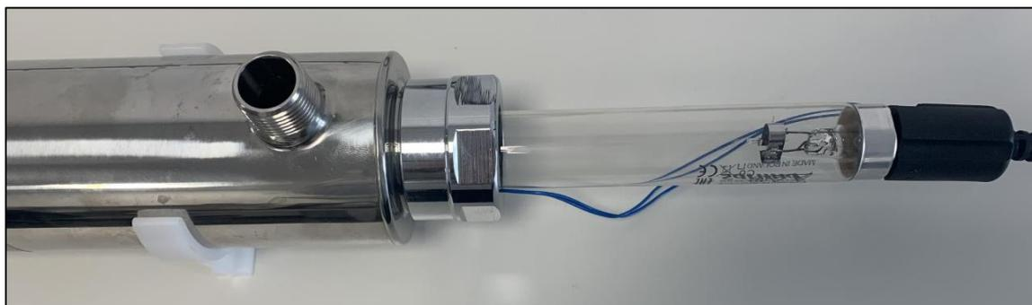
Figura 3-51. Lámpara de luz ultravioleta (3) siendo introducida dentro del tubo de cuarzo (1).
