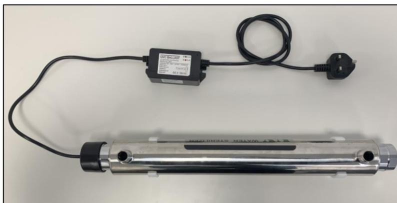
**Figura 3-53. Esterilizador UV completamente montado.**
