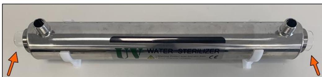
Figura 3-45. Extremos del tubo de cuarzo (1).
