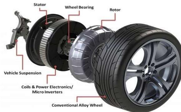
Figura 3-3 Configuración de un motor de rotor exterior intra-rueda
