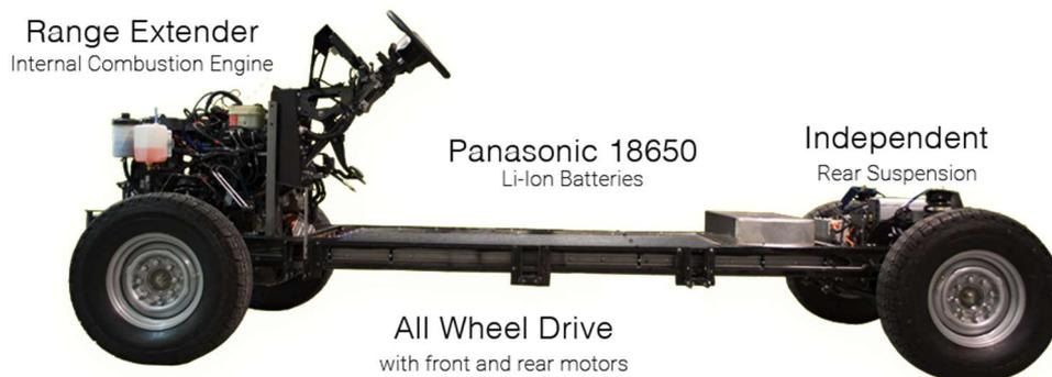
Figura 2-3 Chasis y elementos propulsores del Workhorse W15 [19]
