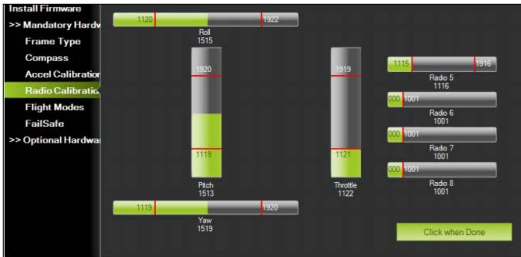
Ilustración 3-30 *Radio Calibration* (Captura de Pantalla).
