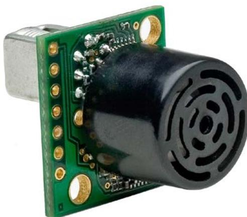
Ilustración 3-9 Sonar Maxbotix 12CXL-EZ4 (Tomado de [36] )
