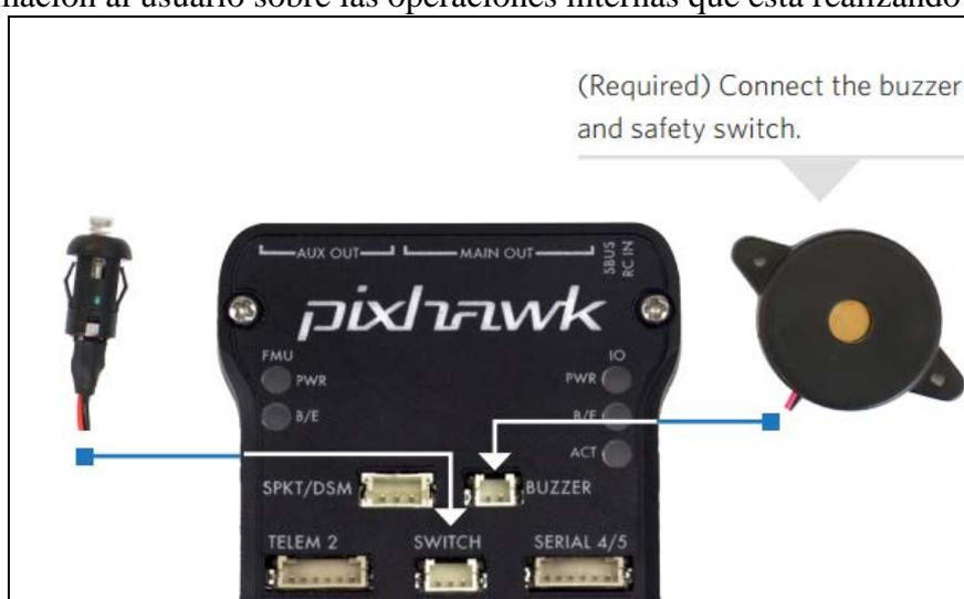
Ilustración 3-32 Conexión Buzzer y Safety Switch (Tomado de [39]).
