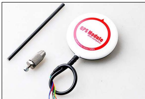
**Ilustración 3-4 Módulo Compás+GPS *Ublox N8M* (Tomado de [32]).**
