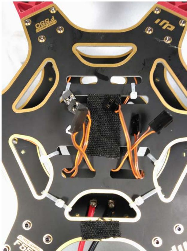
**Ilustración IV-2 Montaje: Tomas de control de los ESC**
