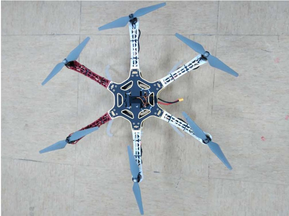
**Ilustración IV-5 Montaje: Módulo DJI Completo**
