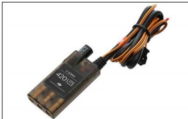
**Ilustración 3-16 ESC DJI 420 Lite (Tomado de [25]).**
