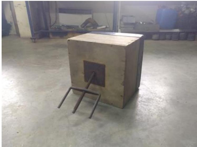
**Ilustración 2-20. Cofferdam con fijado de perno de gancho.**
