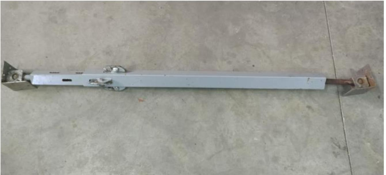
**Ilustración 2-24. Puntal metálico telescópico.**
