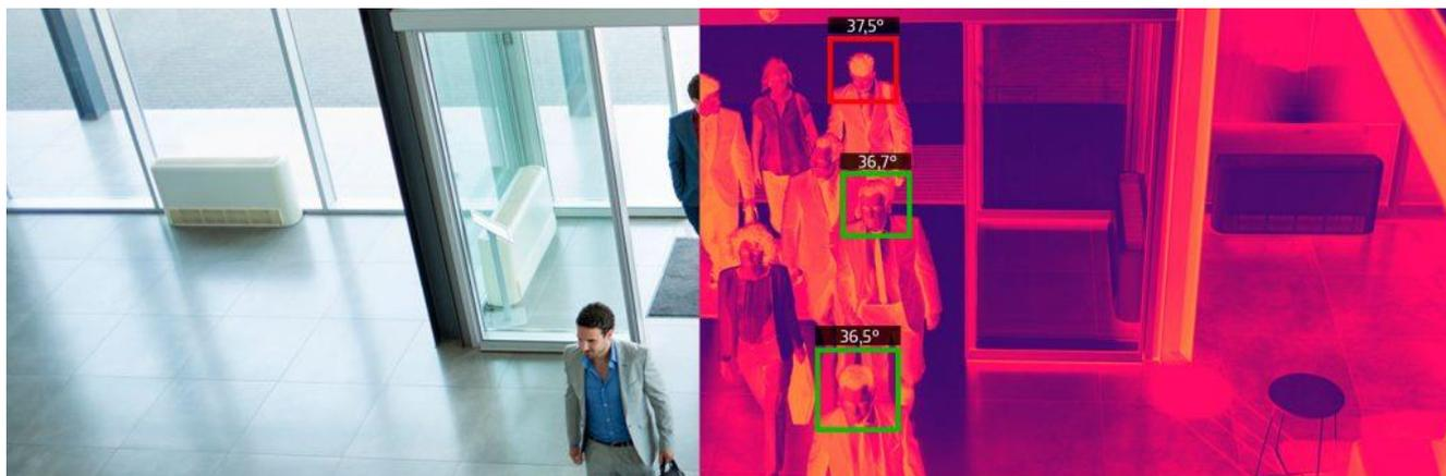
**Ilustración 2-28. Espectro luz visible comparado con la imagen de una cámara termográfica. [16]**
