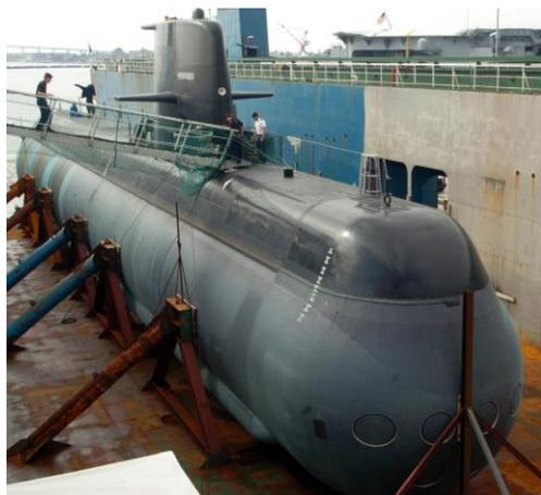
Figura 2-17 Submarino AIP sueco clase "Gotland" en dique seco [38]
