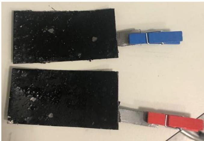
**Figura 3-5 Estado de los electrodos de carbón activo tras su uso**
