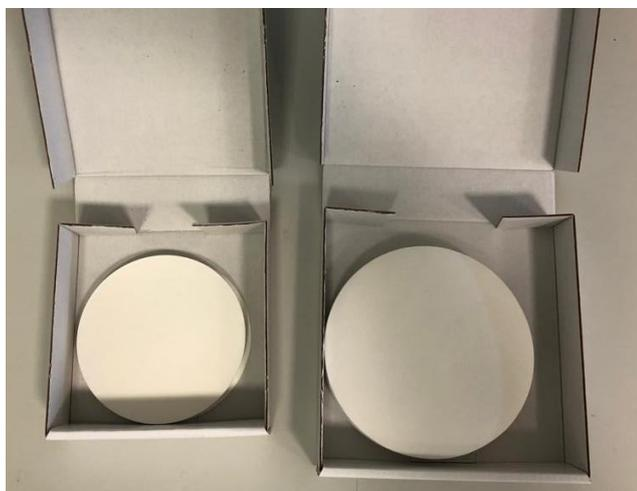
Figura 3-7 Dos de los tres tipos de papel de filtro cualitativo empleados durante los ensayos
