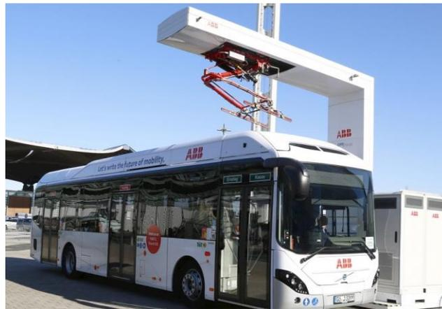
**Figura 1-2 Autobús de la empresa ABB recargando durante una parada [9]**
