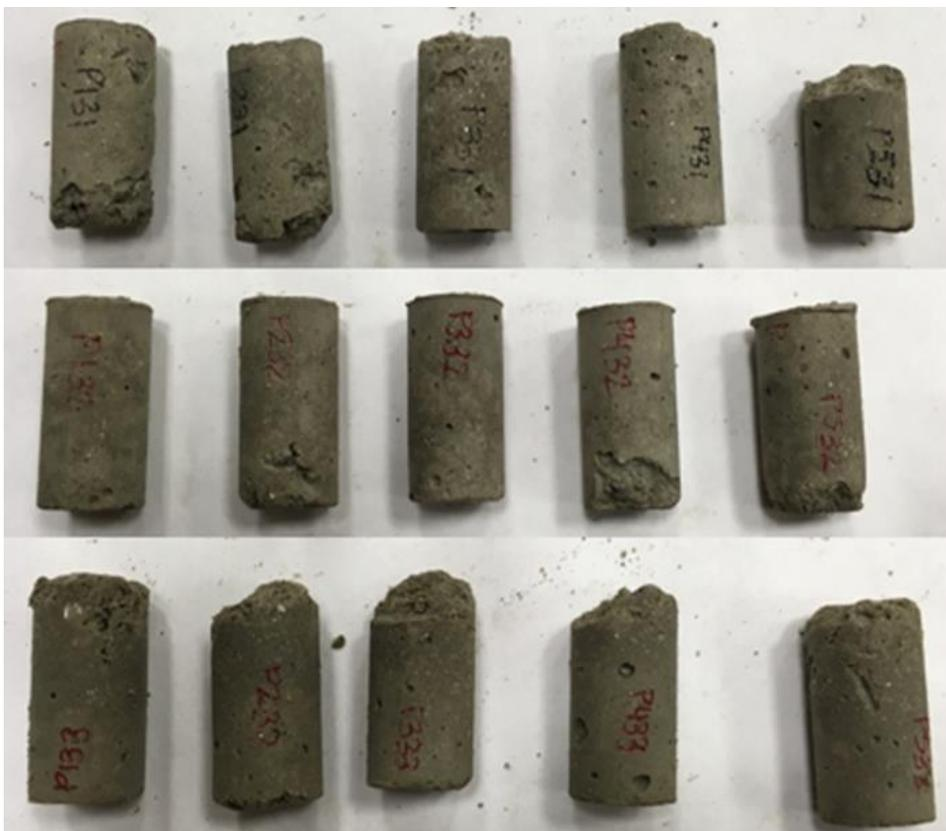
Figura ANEXO X-0-3 Probetas con zinc nitrato (de arriba a abajo: 1, 2 y 3%)
