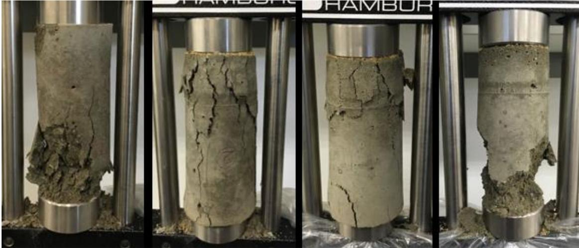
Figura 3-18 Probetas a las 24 horas (de izq. a der. dosificaciónes 1, 2, 3 y 4)
