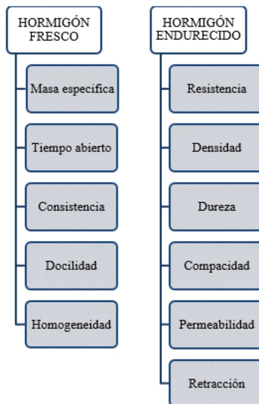
Figura 2-14 Características según el estado del hormigón
