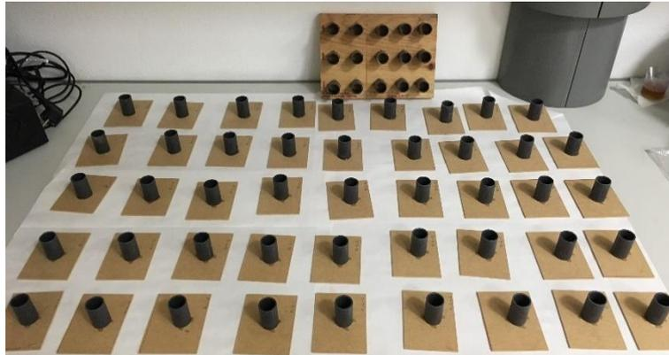
Figura 3-14 Moldes para las probetas pequeñas
