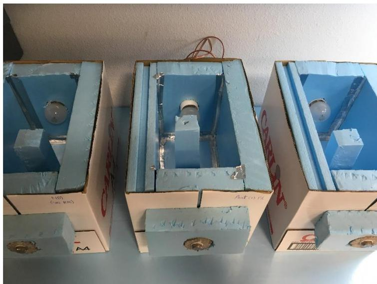
**Figura 3-12 Poliestireno extruido como aislante**
