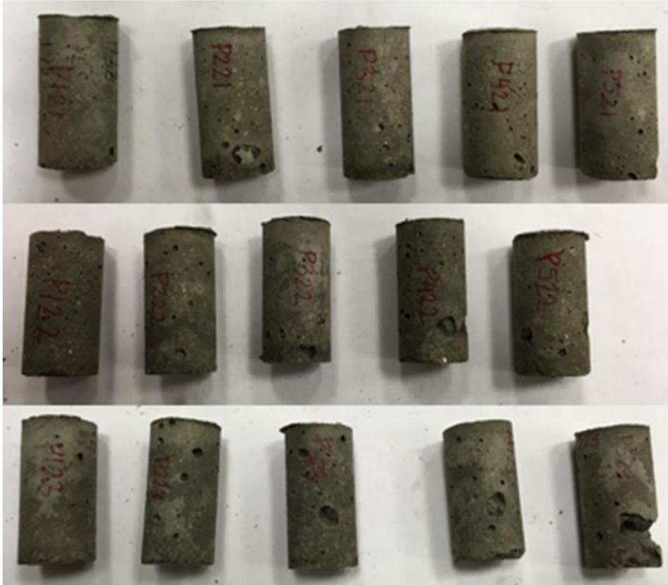
Figura ANEXO X-0-4 Probetas con sodio tiosulfato (de arriba a abajo: 1, 2 y 3%)
