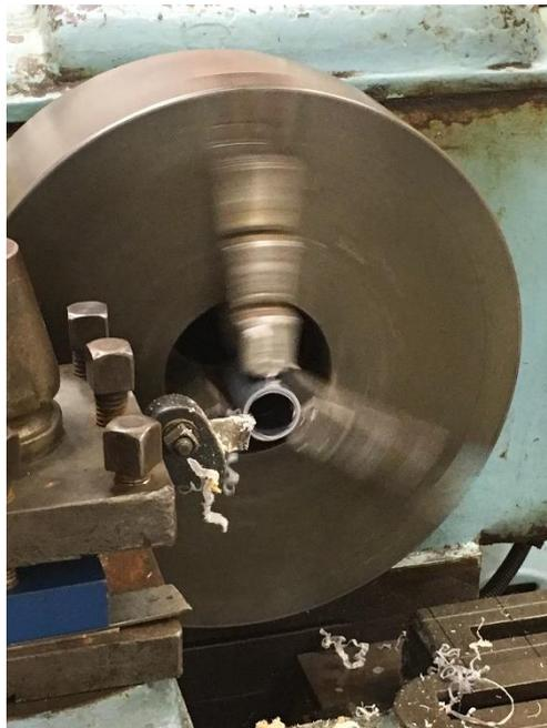
**Figura 3-13 Realización del corte del tubo de PVC**
