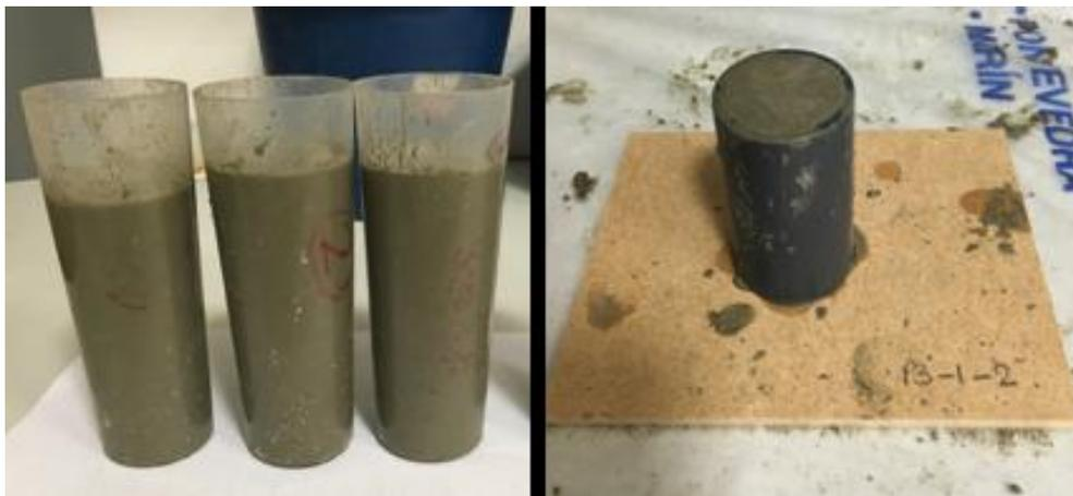
**Figura 3-27 Probetas finales en los moldes**
