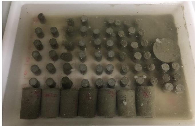
**Figura 3-28** Proceso de hidratación de las probetas pequeñas y el hormigón sobrante de la amasada
