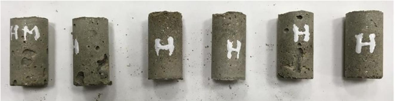
Figura ANEXO X-0-1 Probetas con hormigón de muestra (sin PCM)
