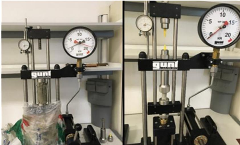
**Figura 3-36 Montaje de la máquina para probetas grandes (izq.) y pequeñas (der.)**
