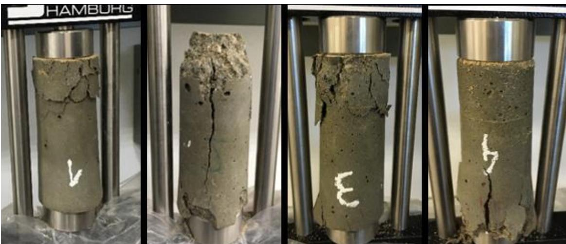
Figura 3-19 Probetas a los 7 días (de izq. a der. dosificaciónes 1, 2, 3 y 4)
