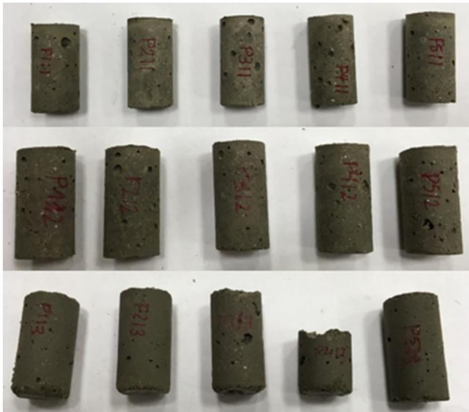
Figura ANEXO X-0-2 Probetas con acetato de sodio (de arriba a abajo: 1, 2 y 3%)
