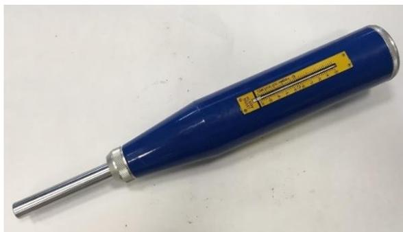
Figura 3-5 Durómetro
