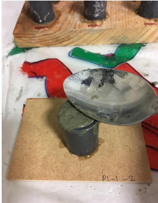
**Figura 3-26 Nivelado de la superficie de la probeta**
