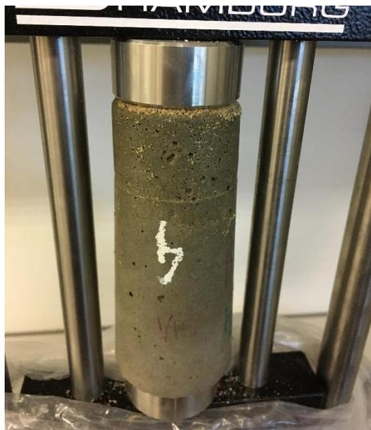
**Figura 3-35 Nivelación de las probetas**
