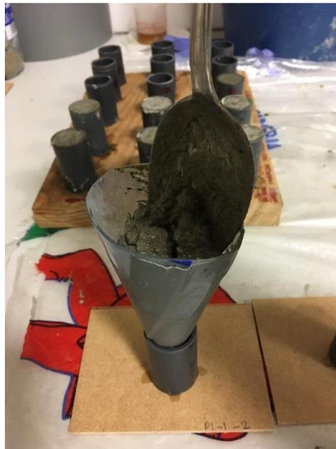
**Figura 3-24 Llenado de las probetas pequeñas**
