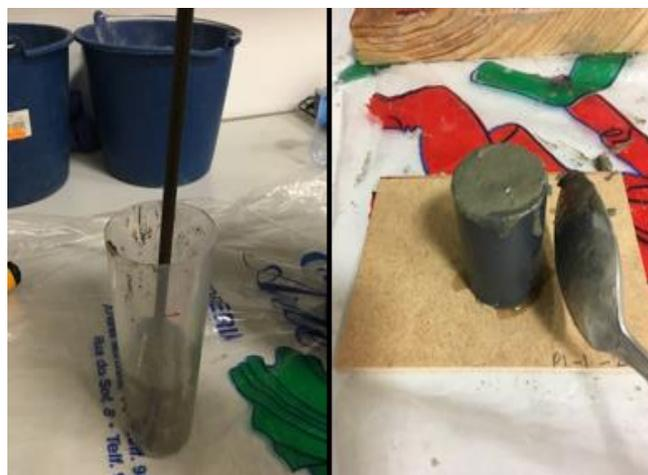
**Figura 3-25 Compactación del hormigón**
