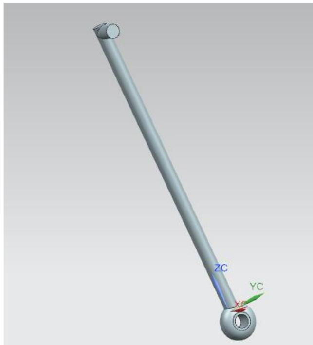
Figura 3-17 Biela pistón de potencia (elaboración propia)
