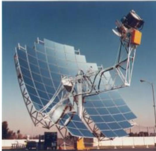
Figura 2-6 Unidad Dish Stirling Engine (tomado de [14])
