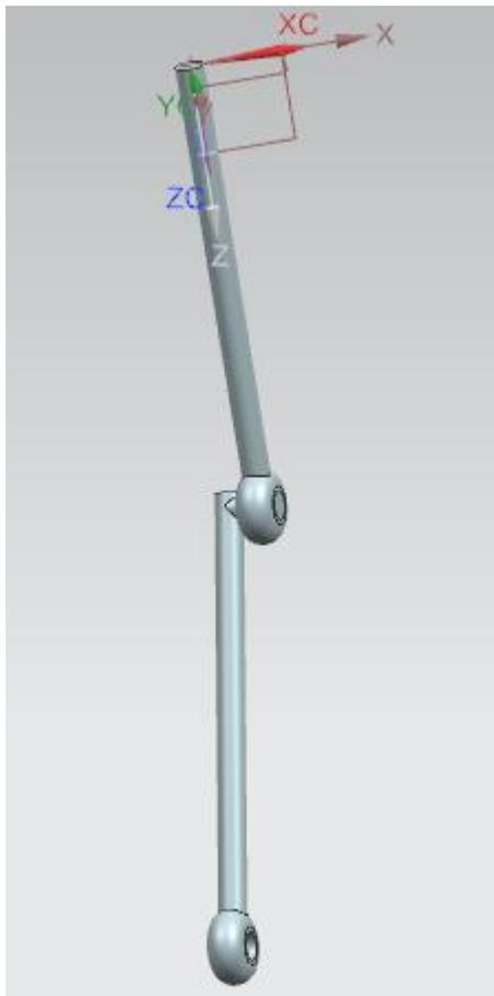
Figura 3-19 Biela del desplazador (elaboración propia)
