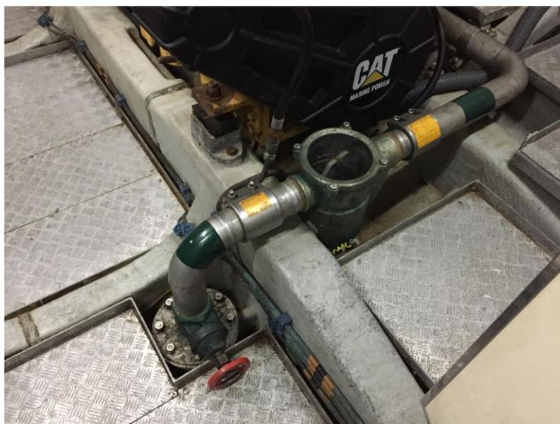
**Figura 3-4 Entrada de agua salada al circuito de refrigeración del motor principal (elaboración propia)**
