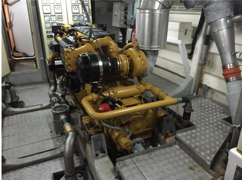
Figura 3-5 Motor de Estribor Caterpillar de la Lancha de Instrucción (elaboración propia)
