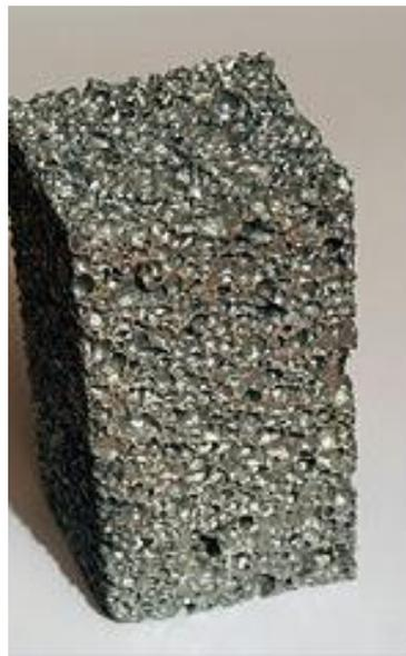
Figura 3-35 Espuma metálica (Tomado de [37])
