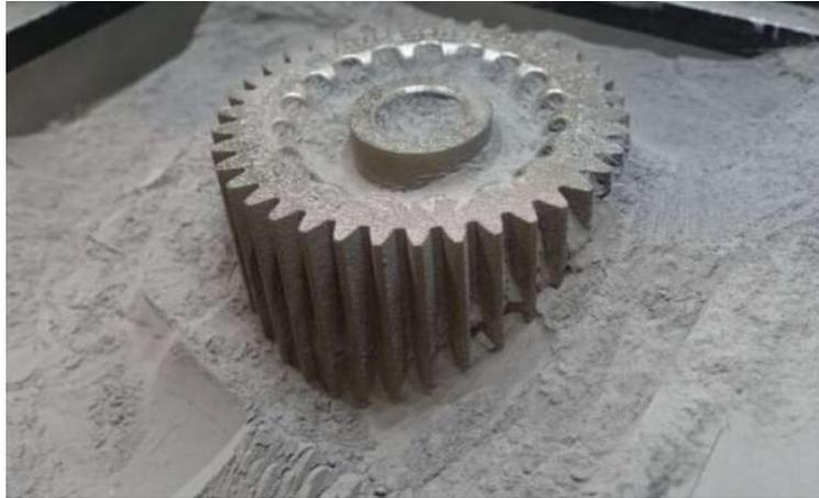
Figura 2-7: Pieza impresa con SLS. [18]
