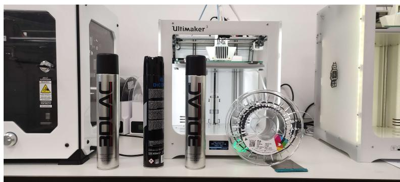
Figura 3-10: Laca adhesiva para la base de impresión.
