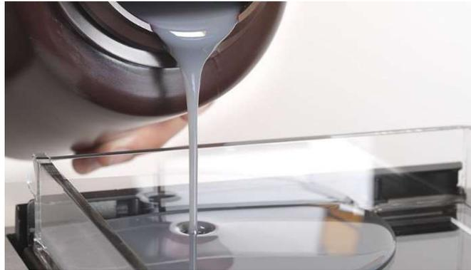
Figura 2-3: Resina fotosensible para impresión SLA. [14]
