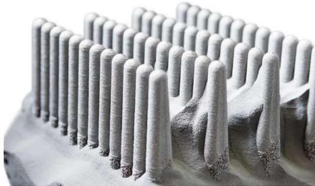
Figura 2-9: Pieza impresa por EBM. [14]
