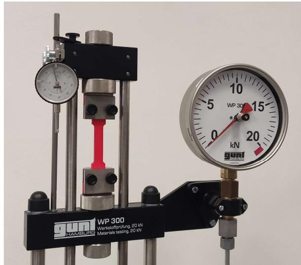
Figura 3-14: Montaje con reloj comparador.
