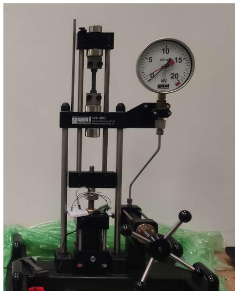
Figura Anexo VIII- 3: Montaje final con el sensor de presión.
