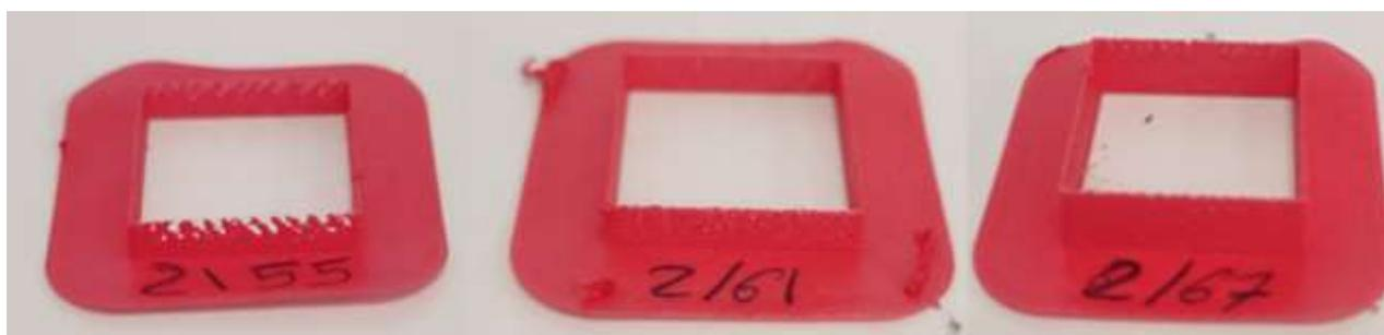
Figura 3-6: Errores de impresión en distintos puntos de la Región 1-1.
