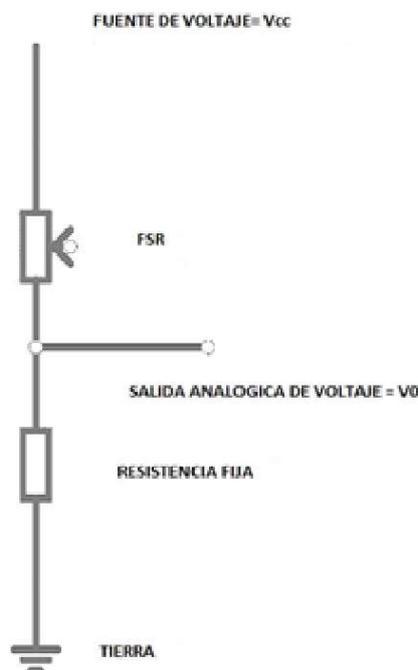
Figura 3-15: Esquema del divisor de tensión.
