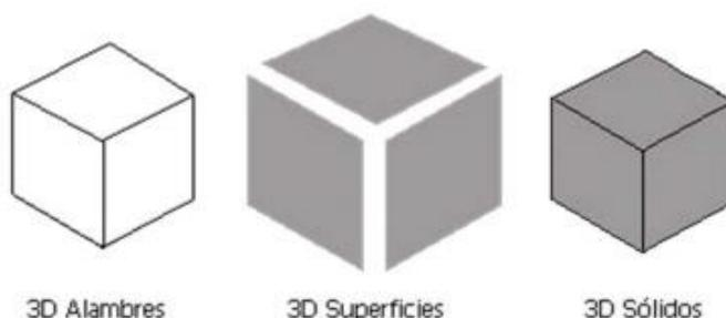
**Figura 2-13 Formas de descripción de elementos en CAD**
