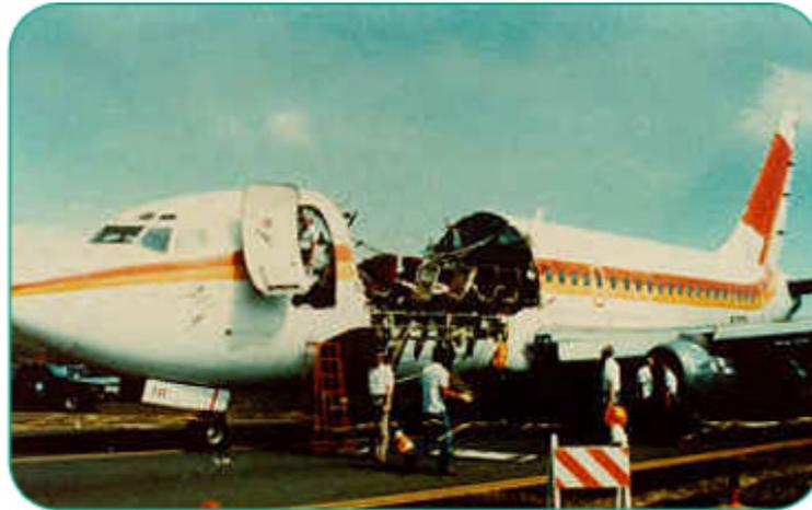
**Figura 1-1 Accidente debido a fallo por fatiga de un avión Boeing 737-297 de la Aloha Airlines 1988**
