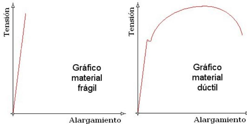
**Figura 2-1 graficas tensión-alargamiento material frágil y dúctil (tomada de [11])**
