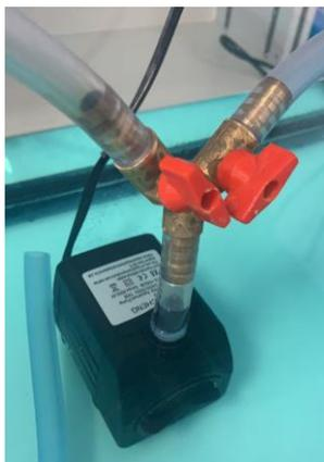
**Figura 3-12. Salida del medio hídrico a través de la bomba y posterior división en dos salidas gracias a válvula de tres vías.**
