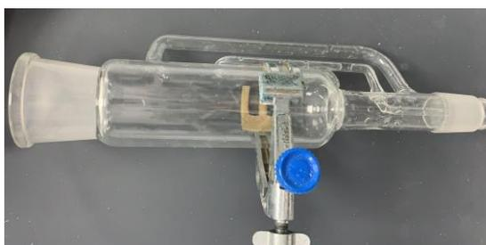
**Figura 3-11. Extractor Soxhlet usado como columna de adsorción**
