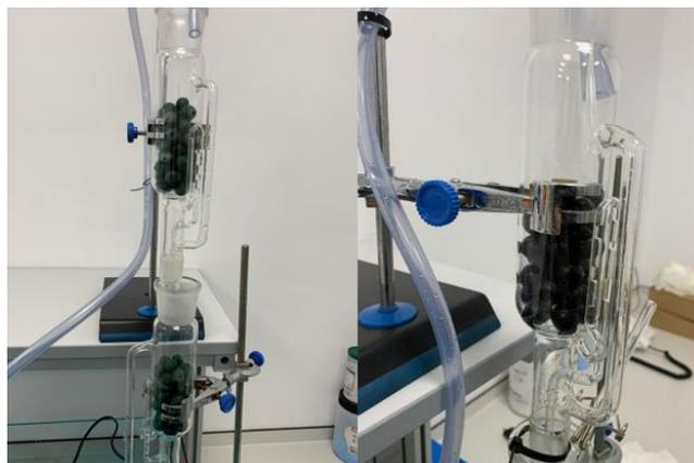
Figura 3-18. Forma de la que quedan colocadas las esferas de adsorbente (Espirulina a la izquierda y carbón activo a la derecha).
