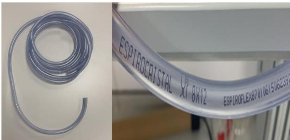
**Figura 3-13. Tubo de espirocristal utilizado en el diseño.**
