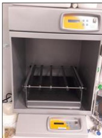
**Figura 3-3 Agitador orbital con incubador**
