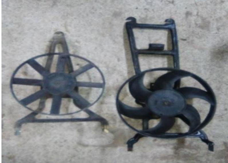
**Figura 3-27. Electroventilador de serie (izquierda) y modificado (derecha).**
