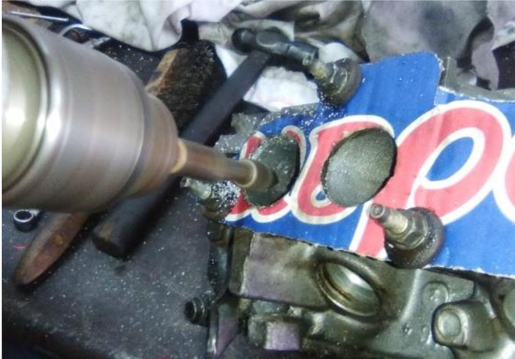
**Figura 3-10. Mecanizado de los conductos de admisión y de escape de la culata.**
