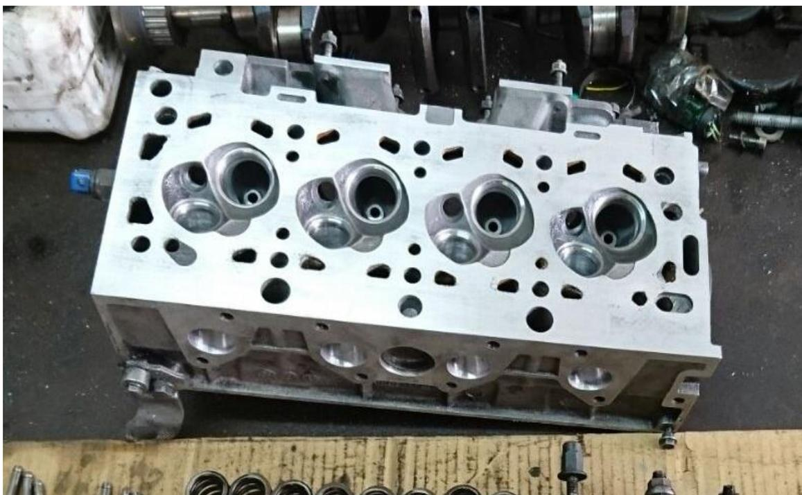
**Figura 3-16. Alojamiento de válvulas en la cámara de compresión.**
