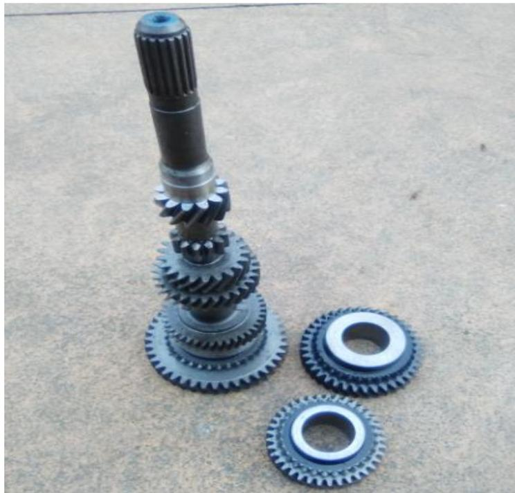
**Figura 3-32. Conjunto de piñones de un Citroën Saxo 16v.**
