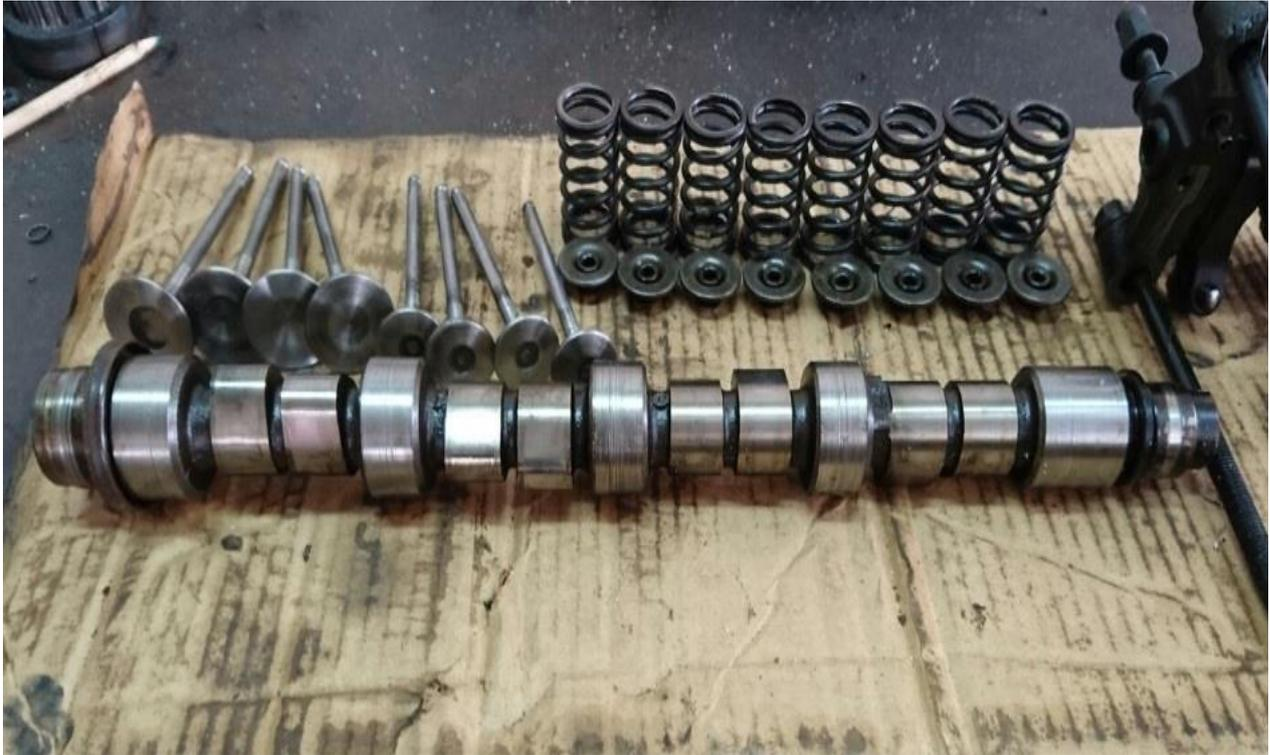
**Figura 2-16. Árbol de levas, válvulas y resortes motor K2A de serie.**
