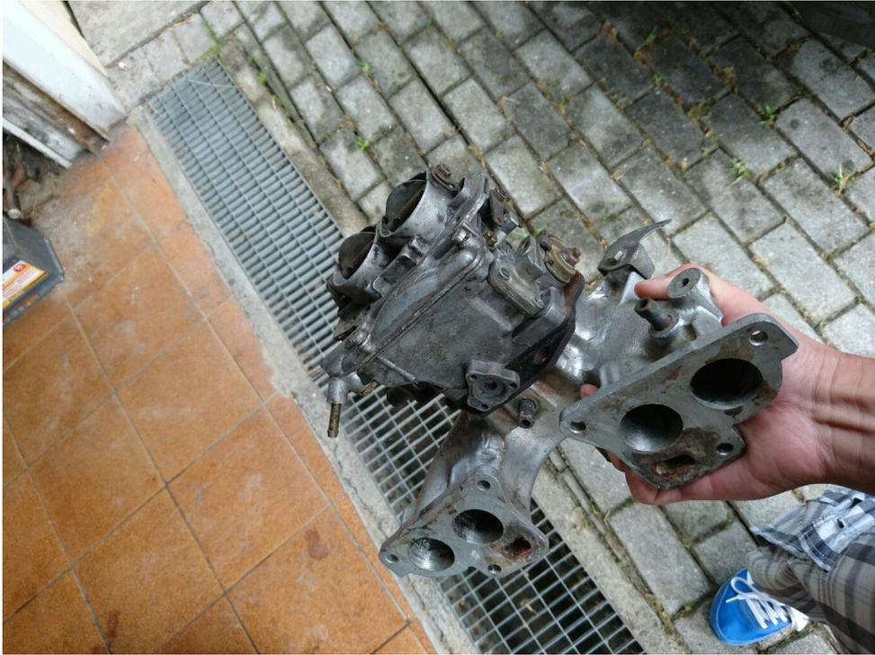
Figura 2-13. Carburador de doble cuerpo de apertura simultánea. Simca 1200.
