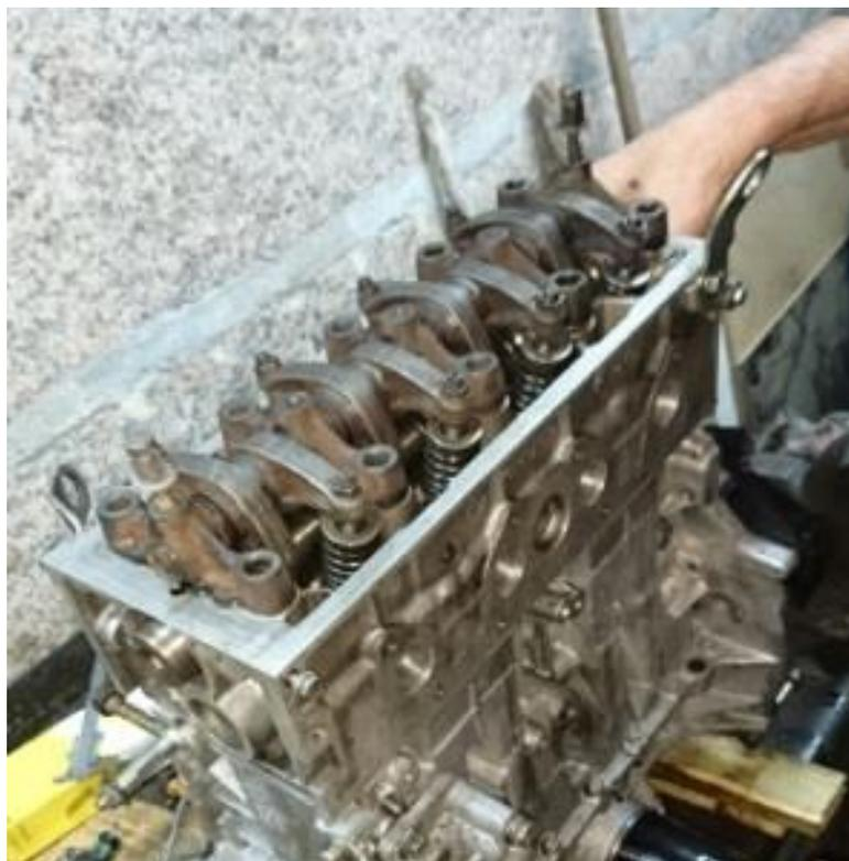
Figura 3-1. Sistema de distribución SOHC. Un solo árbol de levas en cabeza.
