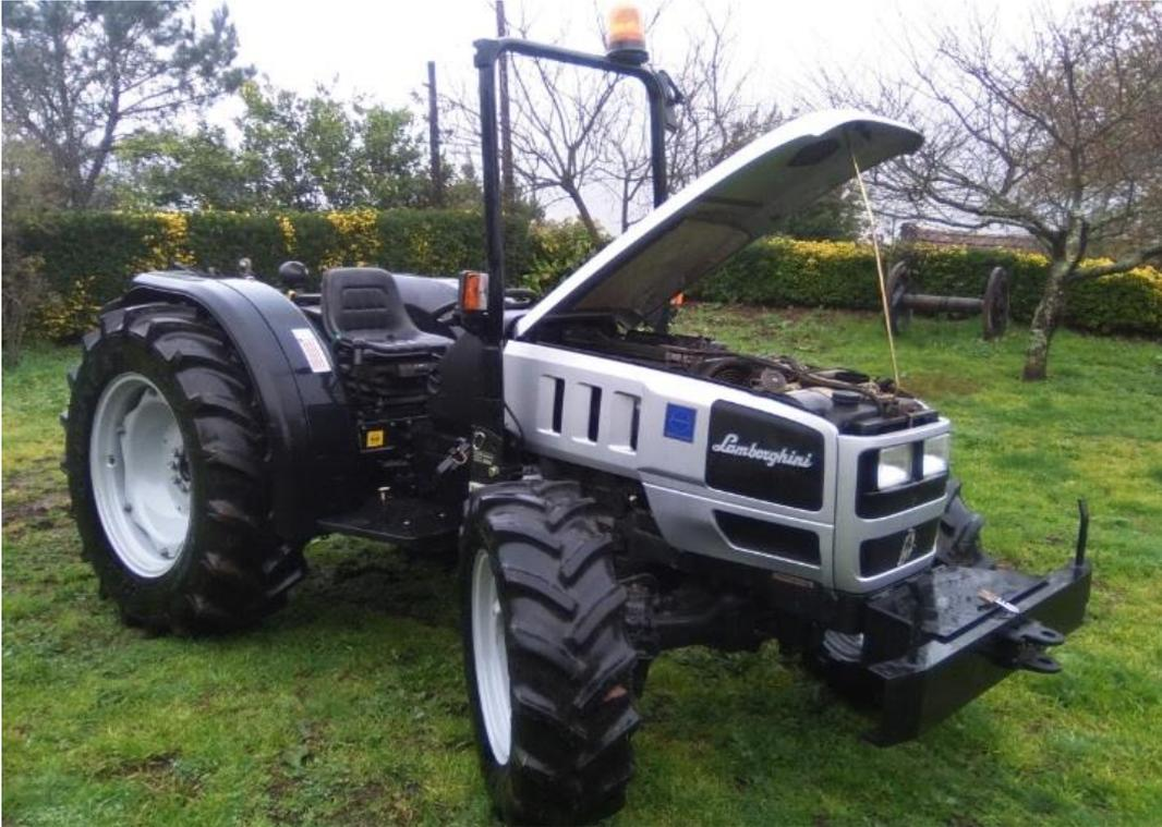
**Figura 2-17. Tractor refrigerado por agua.**
