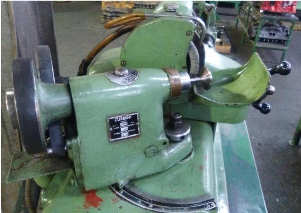
**Figura 3-7. Máquina rectificadora de válvulas.**
