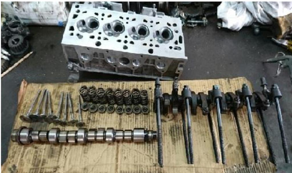
Figura 3-9. Culata motor K2A con su sistema de distribución SOHC.
