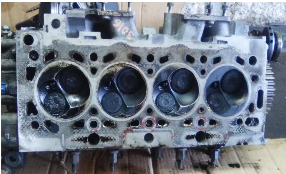
Figura 3-6. Plano de cierre de la culata con el bloque del motor K2A.
