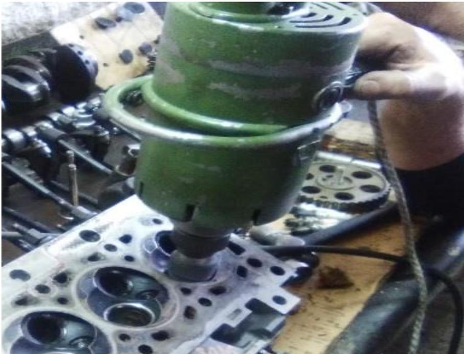
**Figura 3-13.** Máquina rectificadora de asientos de válvulas.
