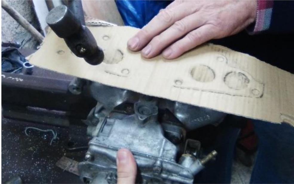
**Figura 3-12.** Plantilla de los conductos de admisión en el carburador.
