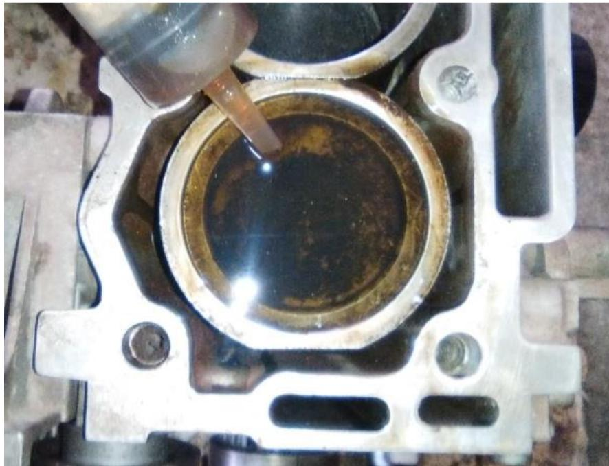
Figura 3-17. Medición del volumen del cilindro en su PMS.
