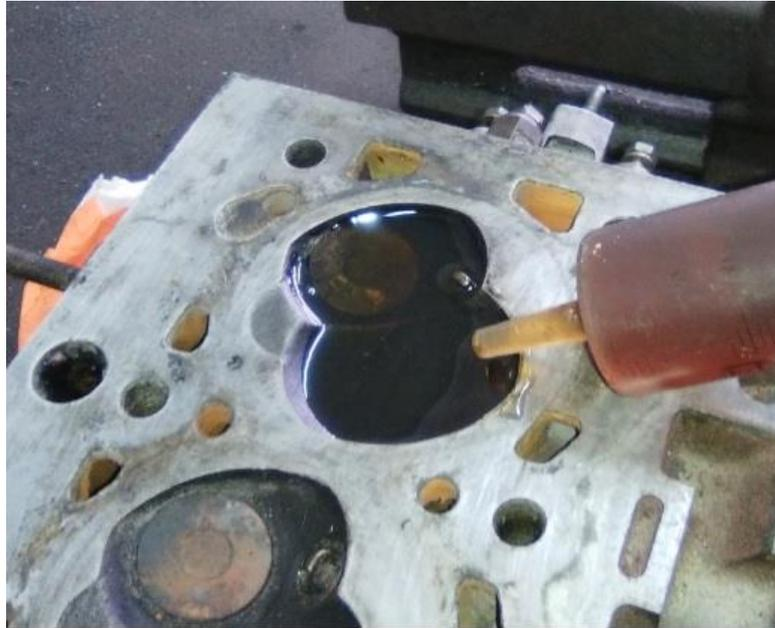
Figura 3-18. Medición del volumen de la cámara de la culata.
