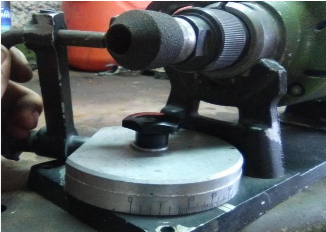
**Figura 3-14. Modificación del ángulo de la piedra de carborundum.**
