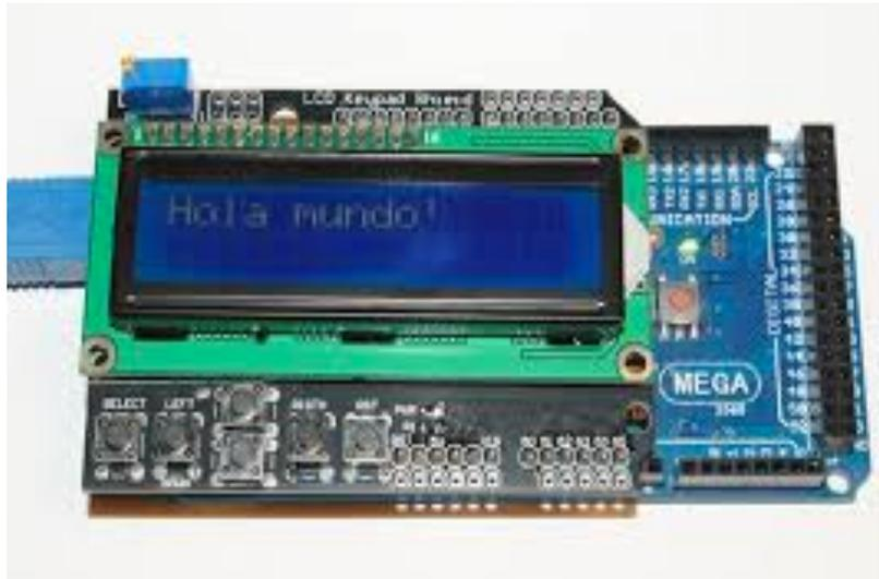
Figura 3-2 Arduino Mega con pantalla configurada con “Hola mundo”.
