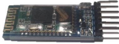
**Figura 2-3 Foto realizada del módulo HC-05.**
