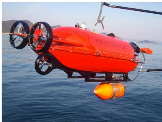
**Figura 5-9 El ROV Pluto Plus preparado para una operación [45].**
