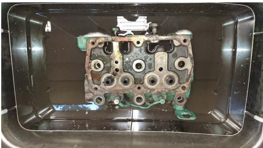
**Figura 3-4 Culata en proceso de limpieza**
