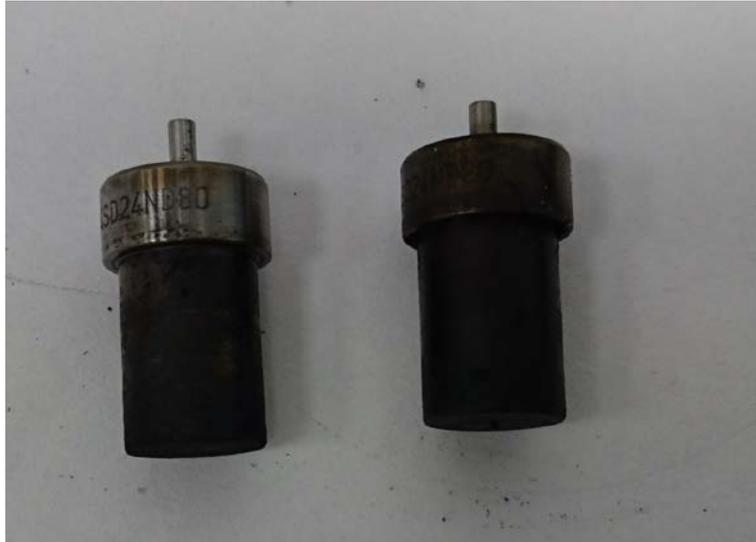
Figura 3-13 Comparación inyectores antes y después de limpieza ultrasónica
