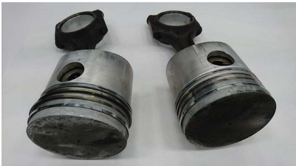
**Figura 3-12 Comparación Pistón limpio (50°C) – Pistón limpio (30°C)**
