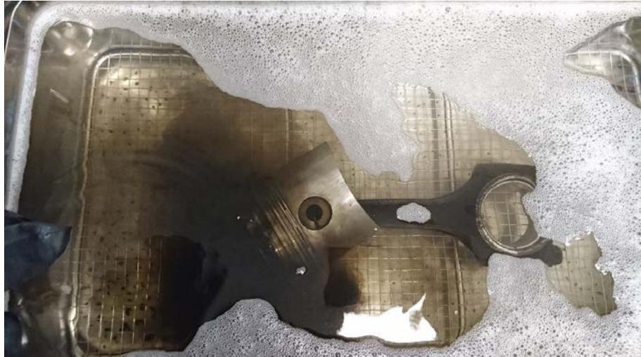
**Figura 3-7 Pistón sumergido en equipo ultrasonidos**
