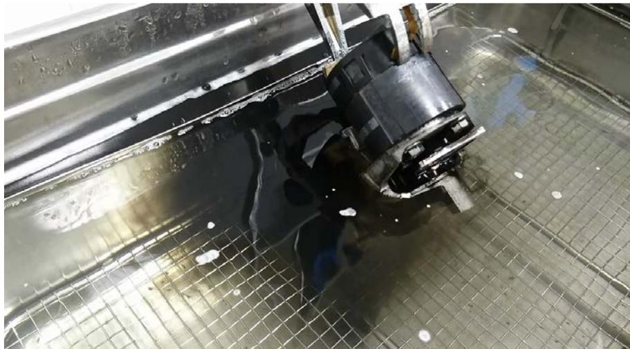
**Figura 3-34 Bobina de encendido sumergida en baño ultrasónico**
