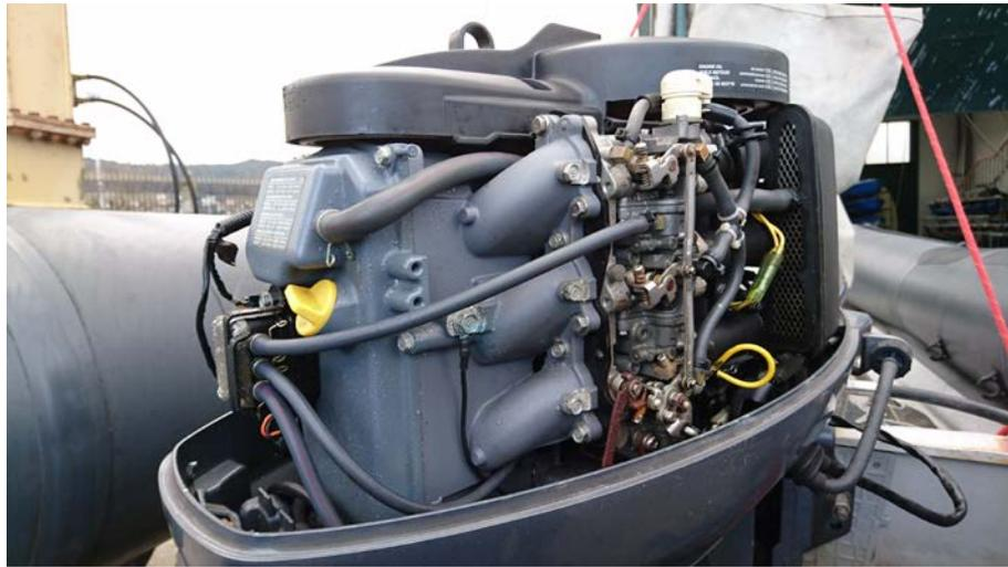
**Figura 3-40** Carburadores montados en motor Fueraborda Yamaha F40B
