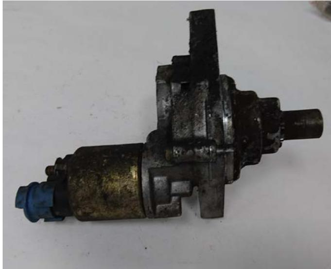
**Figura 3-31 Motor de arranque sucio**
