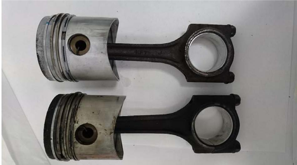
**Figura 3-9 Comparación Pistón limpio (30 °C) – Pistón sucio**
