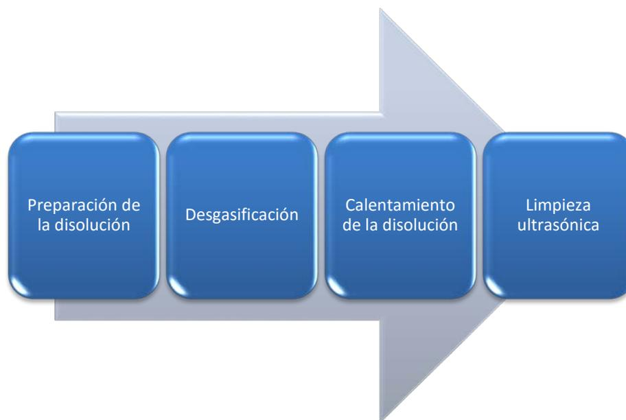
**Figura 3-2 Gráfico del procedimiento seguido en limpieza ultrasónica**
