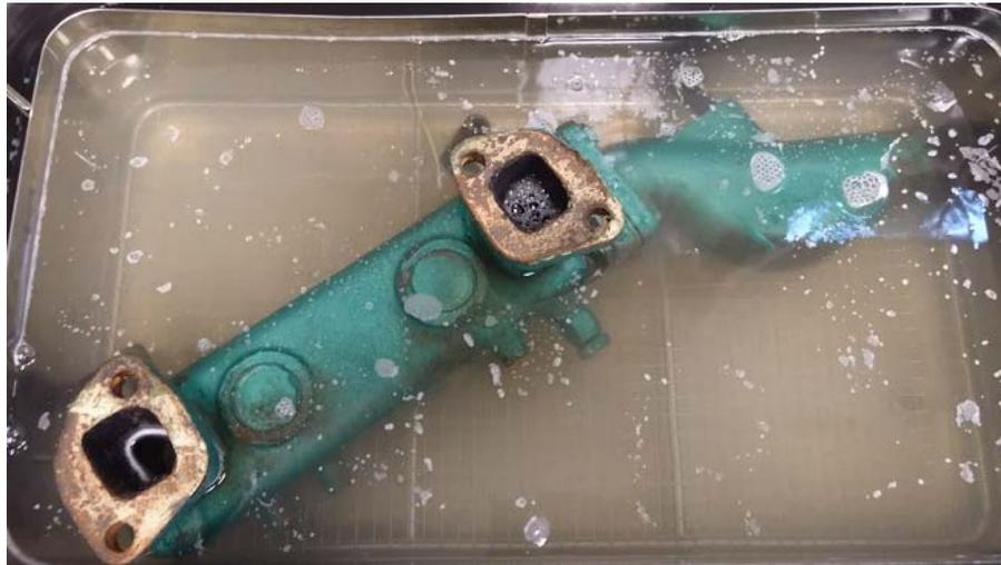
**Figura 3-19 Conducto expulsión de gases sucio**
