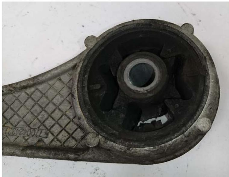
**Figura 3-26 Soporte de motor sucio parte circular**
