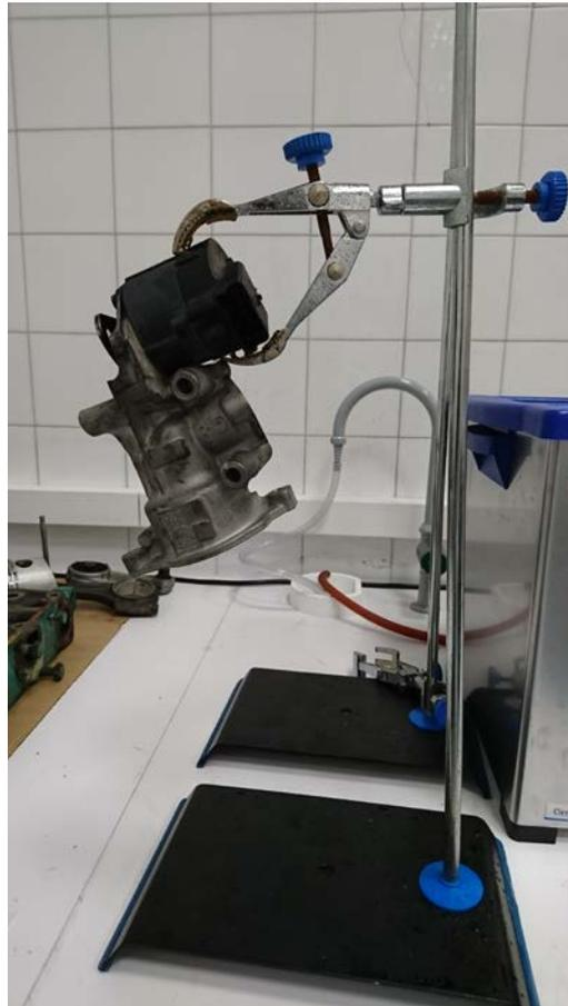
**Figura 3-35 Método empleado para no sumergir pieza integra**
