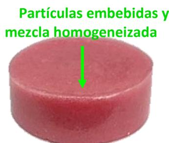
Figura 2-24. Muestra homogénea tras adicionar espesante.
