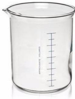
Figura A3-2. Vaso de precipitado de cristal sin graduación numérica.
