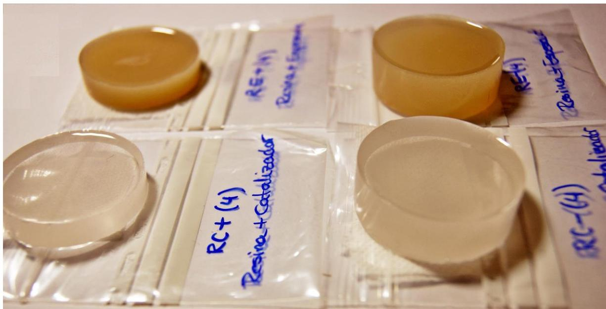
Figura A3-24. Detalle de las probetas puras en resina (transparentes) a dos niveles.
