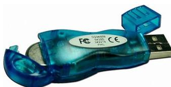
Figura 3-1. Lector USB de sensores iButton.
