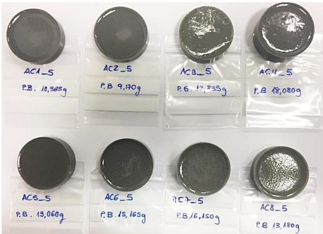
Figura A3-22. Vista en planta de las superficies de las probetas en contacto con el ambiente para sesión 5.
