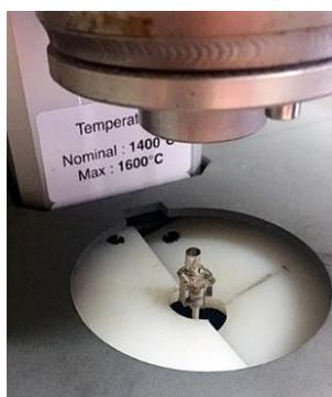
1. Encender el equipo TG-DTA/DSC y el refrigerador (Poner a 20°C, en caso de olvidarse, el propio equipo tiene incorporado un sistema que dejaría de funcionar alcanzados los 100°C).
