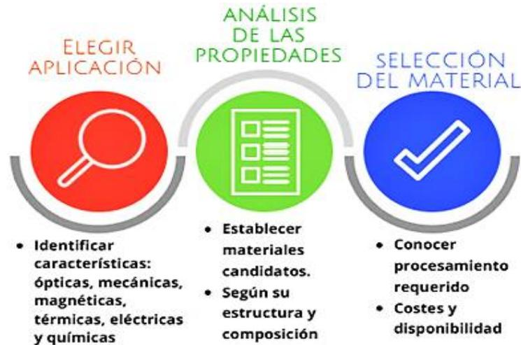
Figura 2-2. Esquema del proceso de selección de los materiales.
