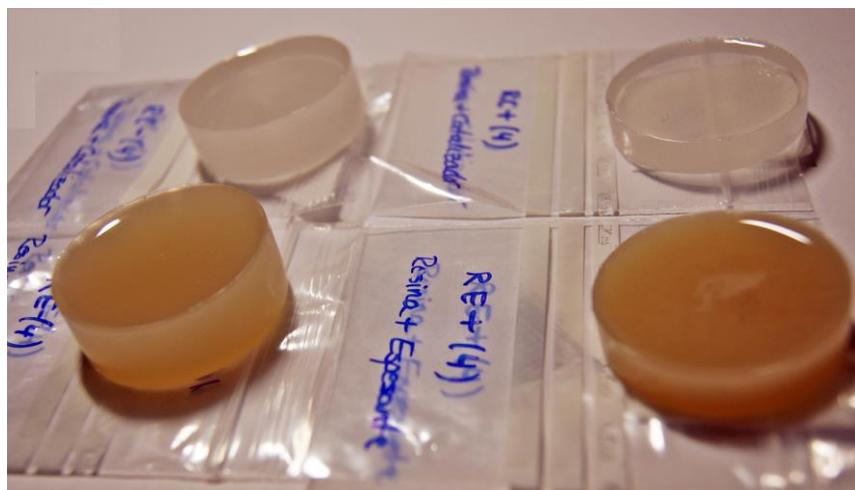
Figura A3-23. Detalle de las probetas combinación de resina y espesante (amarillas) a dos niveles.
