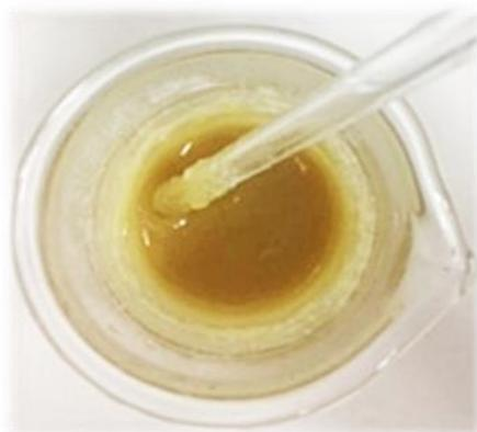
Figura A3-4. Varilla agitadora usada para batir la mezcla multicomponente en vaso de precipitado.
