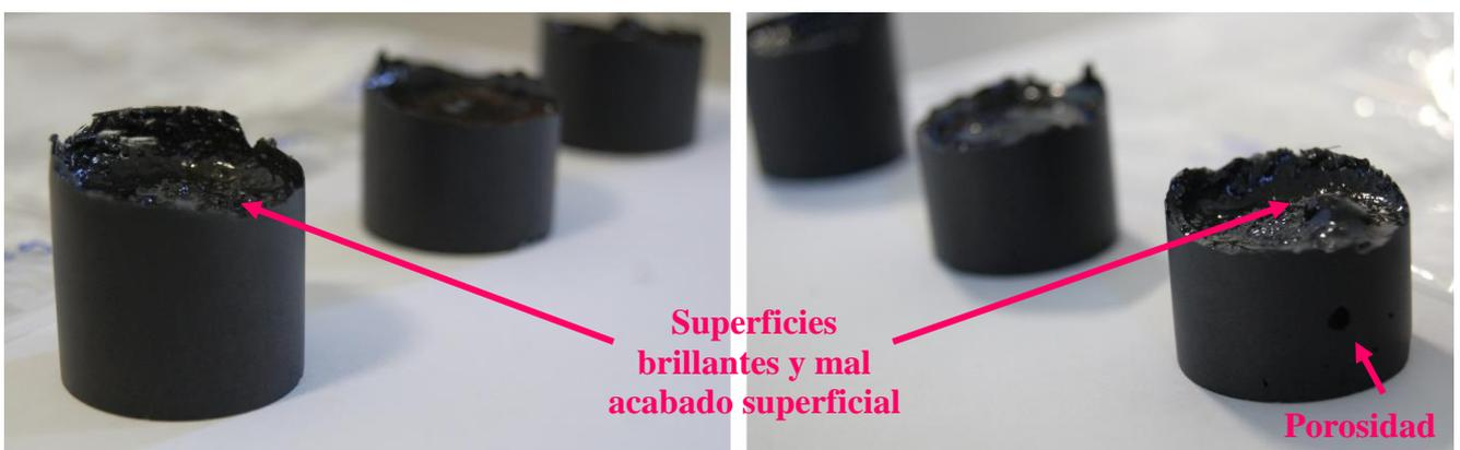
Figura A3-14. Vista de las características físicas de las probetas al grafito.
