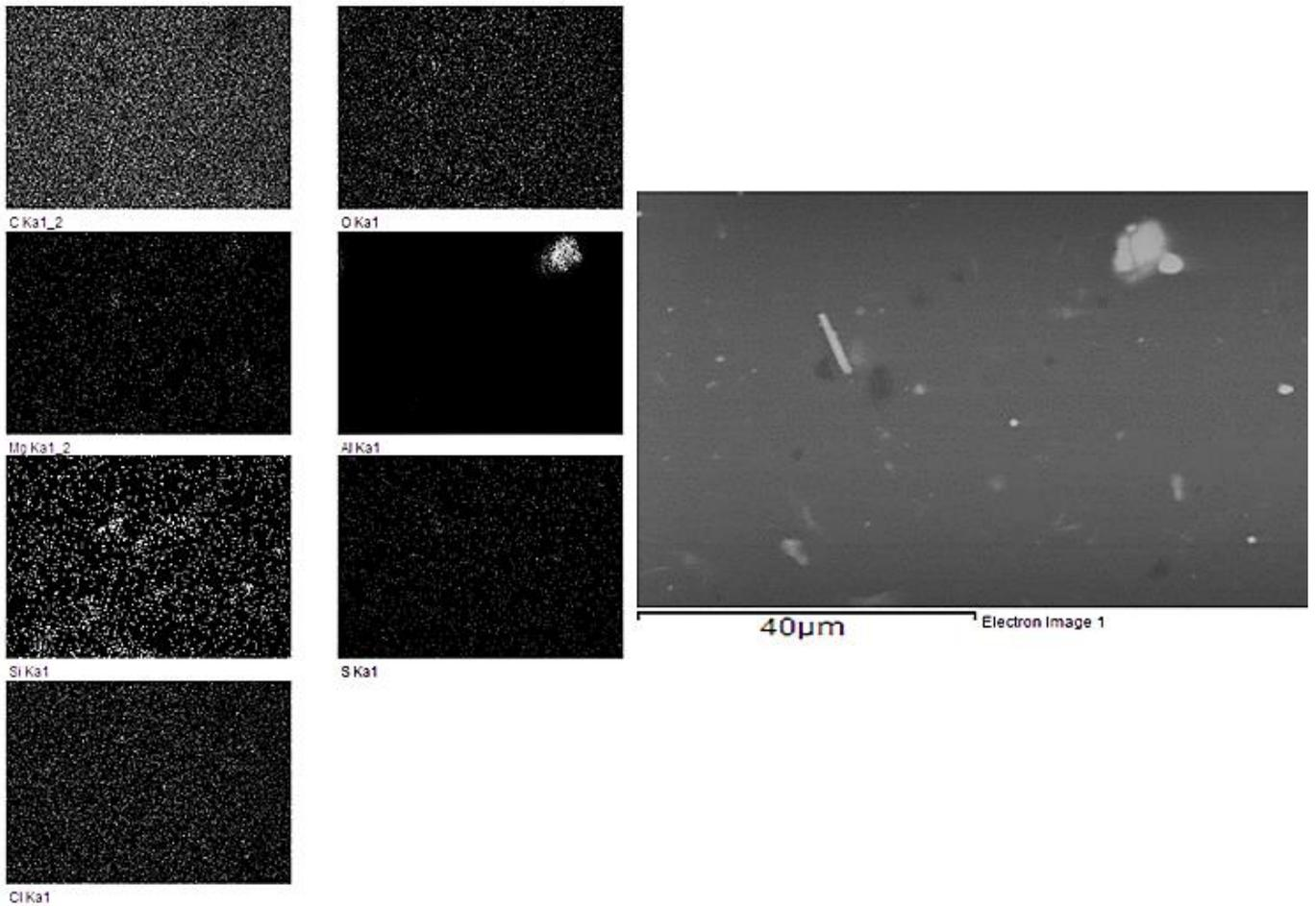
**Figura 4-48. Mapeo y composición de la muestra para un enfoque puntual de 40µm.**
