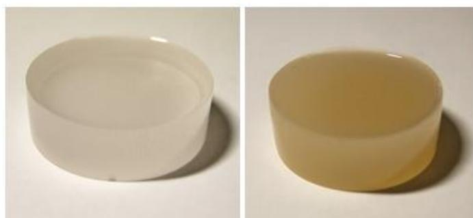
**Figura 3-10. Probetas correspondientes a resina+ catalizador y resina+ catalizador+ espesante.**
