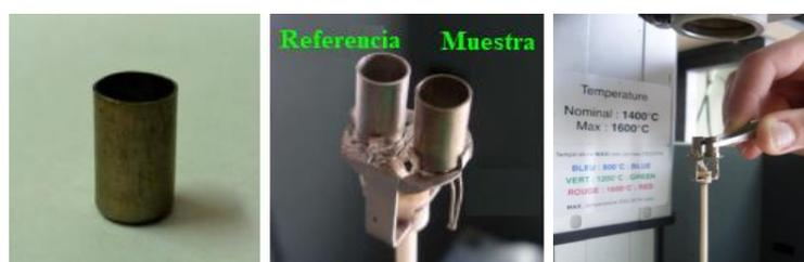
Figura 3-12. Detalle de los crisoles de platino en la termobalanza.
