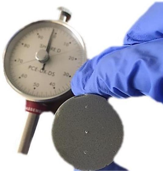
**Figura 3-18. Huellas de indentación de una probeta en la cara inferior.**
