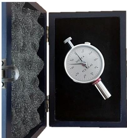
**Figura 3-16. Durómetro PCE-DX AS.**
