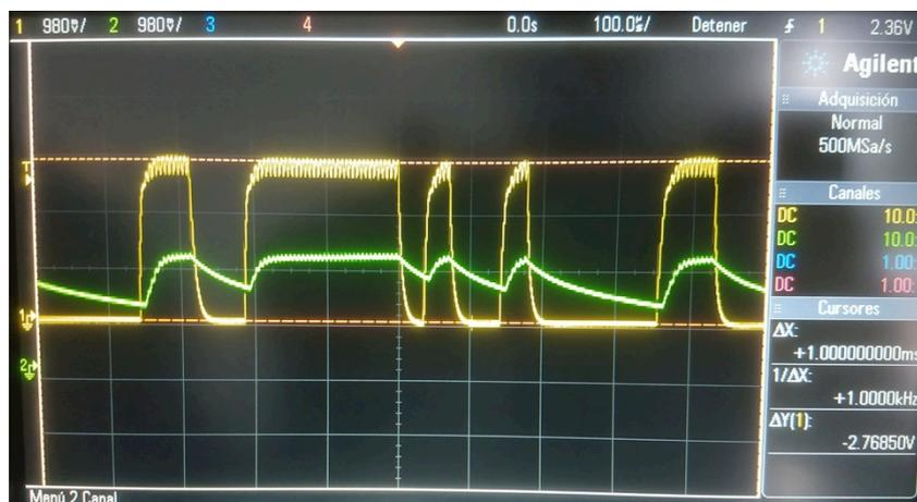
Figura 3-47 Comparación de la señal del láser (amarillo) y la señal de la placa solar (verde)
