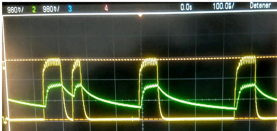
Figura 4-5 Comparación entre la señal del láser (amarillo) y la placa (verde)
