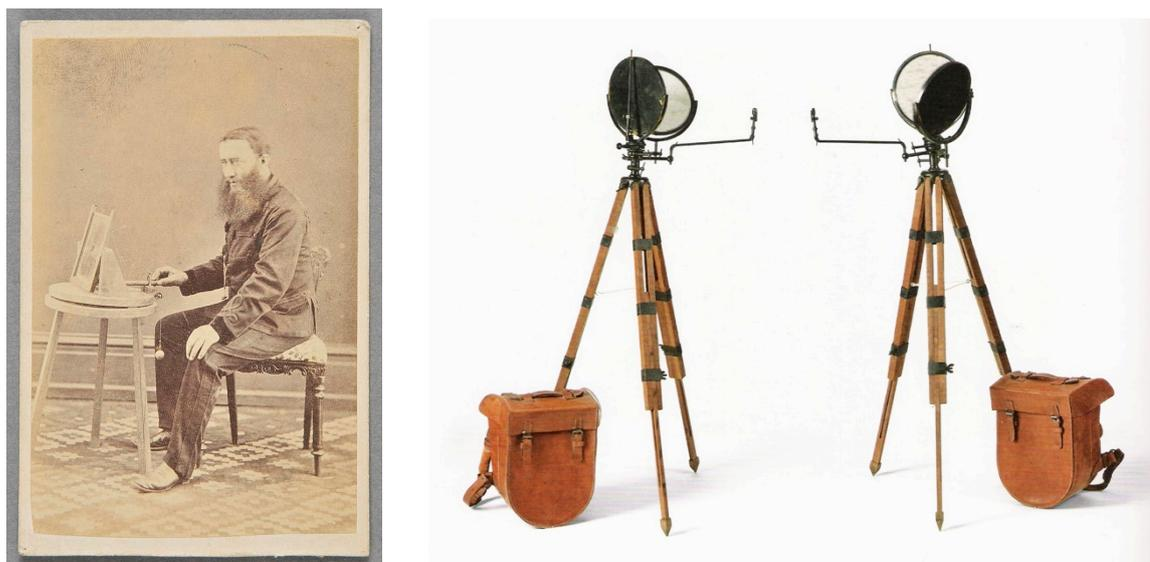
**Figura 2-1 Henry Mance junto al prototipo del heliógrafo (izquierda) y dos heliógrafos de campaña (derecha) [12]**
