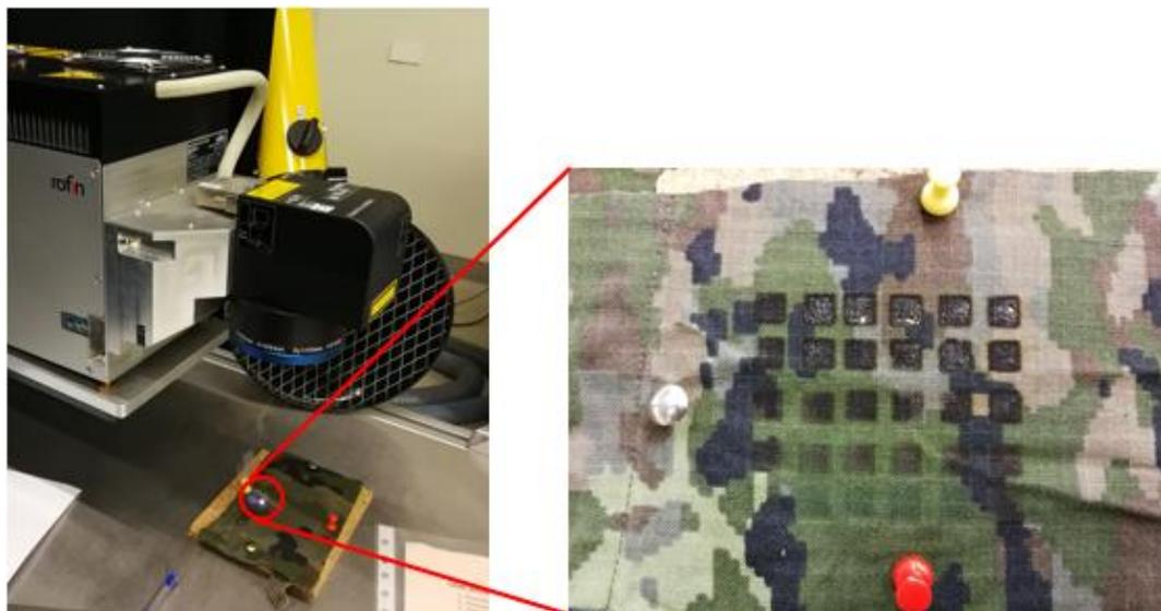
Figura 3-23 Láser de picosegundos en funcionamiento y superficie texturizada
