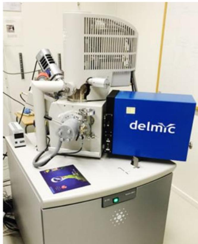
**Figura 3-12 Microscopio SEM. Universidad de de Vigo C.A.C.T.I [13]**
