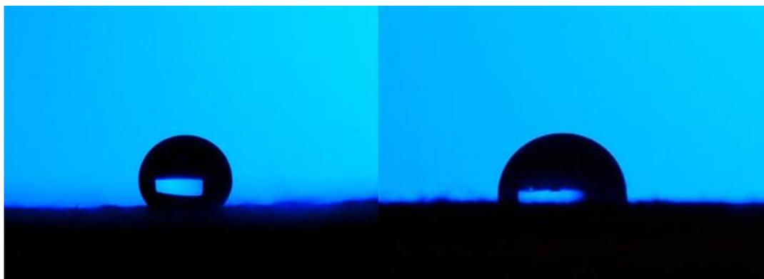
Figura 4-38 Ángulos de contacto conseguidos con el láser de picosegundos en el ensayo 03 (derecha) y el ensayo 19 (izquierda)
