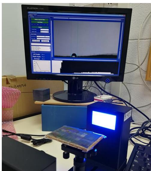
Figura 3-24 Medición de ángulos con el Goniómetro Ossila
