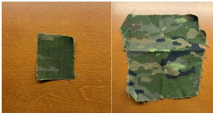
**Figura 3-3 Ejemplo muestra para análisis químico (izquierda) y muestra para análisis físico (derecha)**
