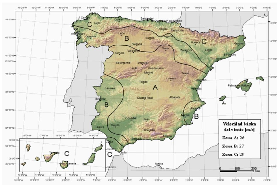
Figura 3-6 Valor básico de la velocidad del viento (tomada de [6])
