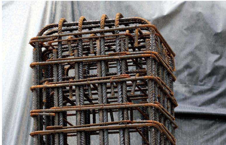
**Figura AIV-5 Armadura de acero (tomada de [45])**
