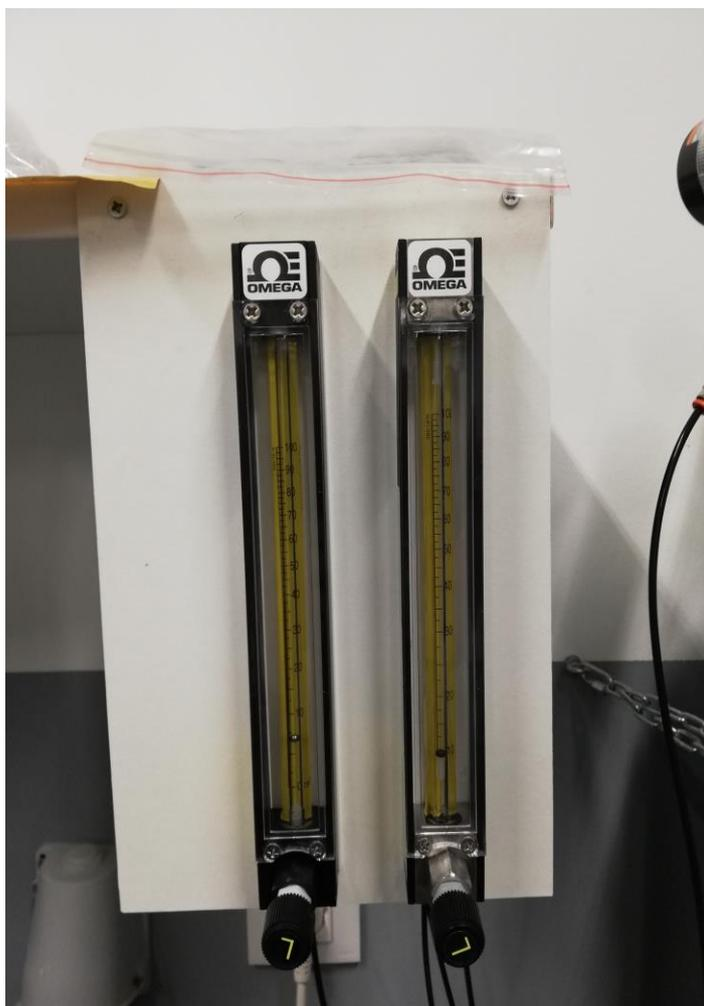
**Figura 3-3 Caudalímetro N<sub>2</sub> (derecha) y aire (derecha).**
