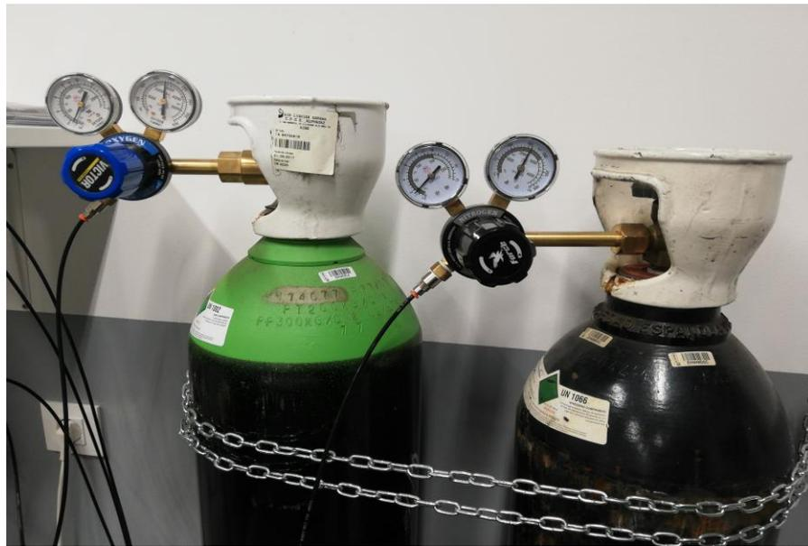
Figura 3-4 Botellas de aire (izquierda) y N<sub>2</sub> (derecha).
