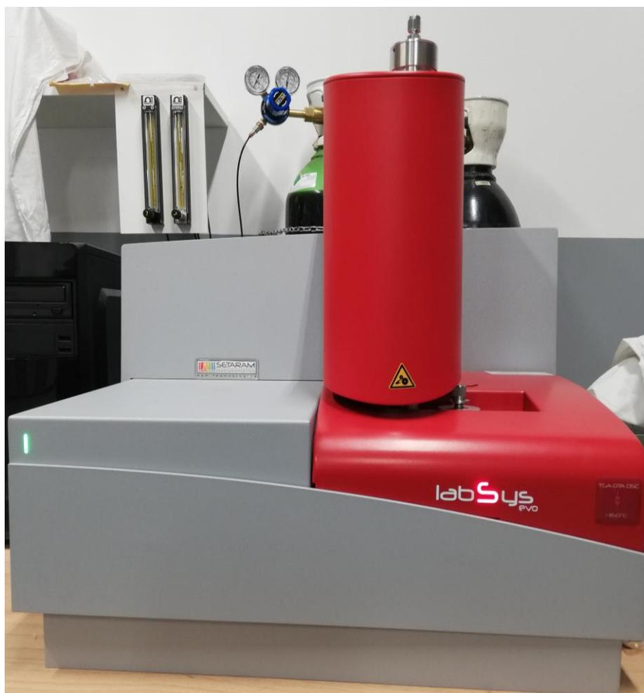
Figura 3-2 Equipo termogravimétrico LABSYS EVO-1A.
