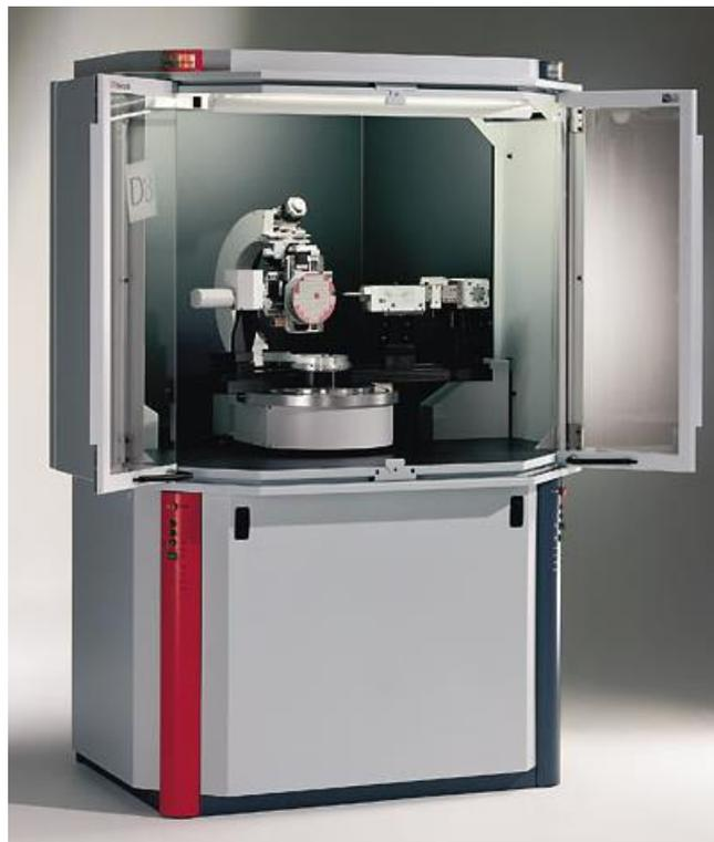
**Figura 2-11** Equipo de difracción de rayos X (XRD).
