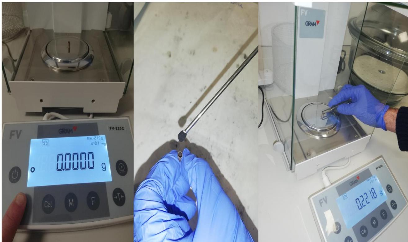
**Figura 3-17** Proceso seguido en el pesado de la muestra.
