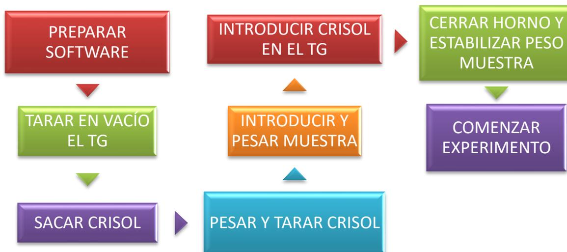
**Figura 3-11** Esquema general del procedimiento seguido.
