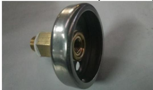
Figura 3-10 Boca de carga para gas
