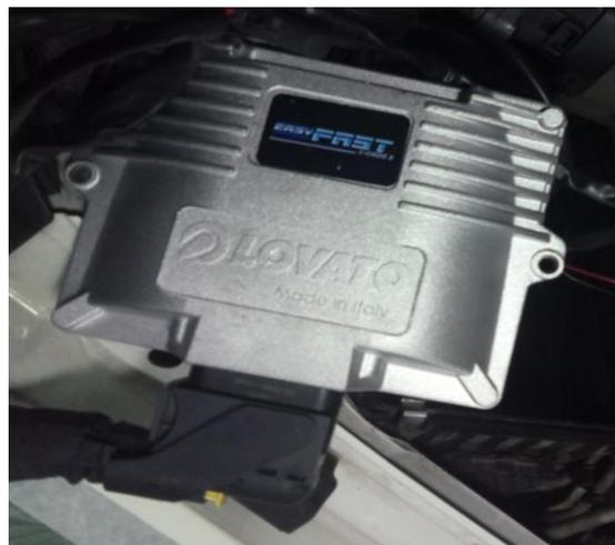
**Figura 3-18 Centralita de control de gas**
