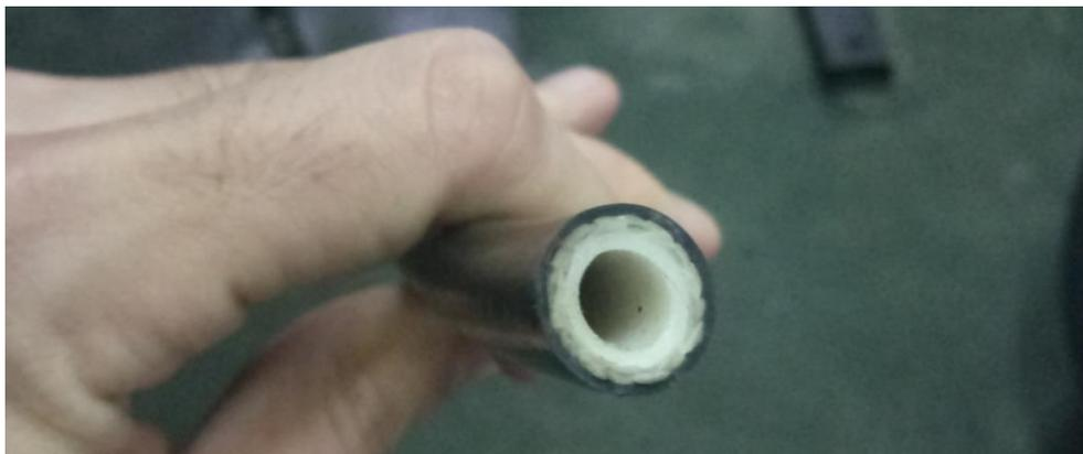
**Figura 3-13 Línea de gas a alta presión**
