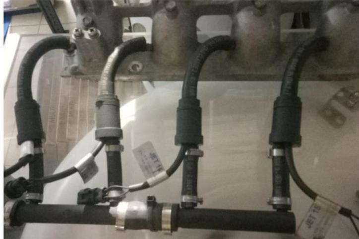
**Figura 3-17 Rampa de 4 cilindros de gas**
