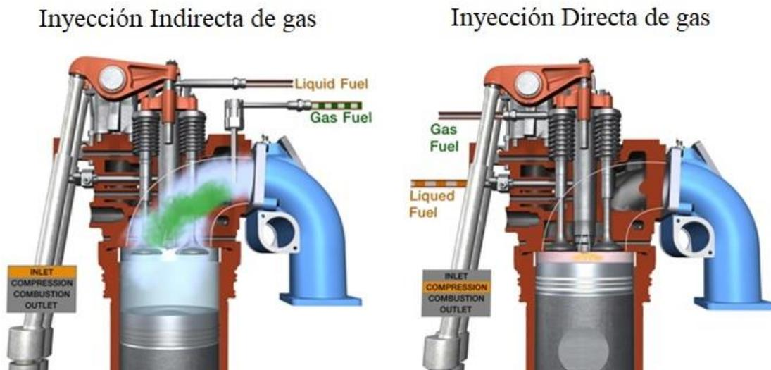
Figura 2-12 Inyección indirecta e inyección directa dual fuel [31]
