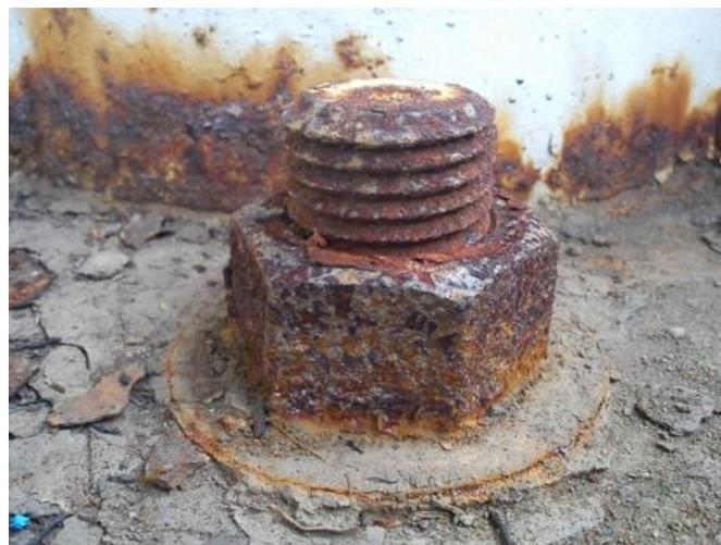
**Ilustración 6 Corrosión galvánica [6]**
