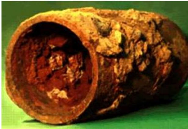
**Ilustración 32 Corrosión tubería de cobre en instalación hidráulica [46]**
