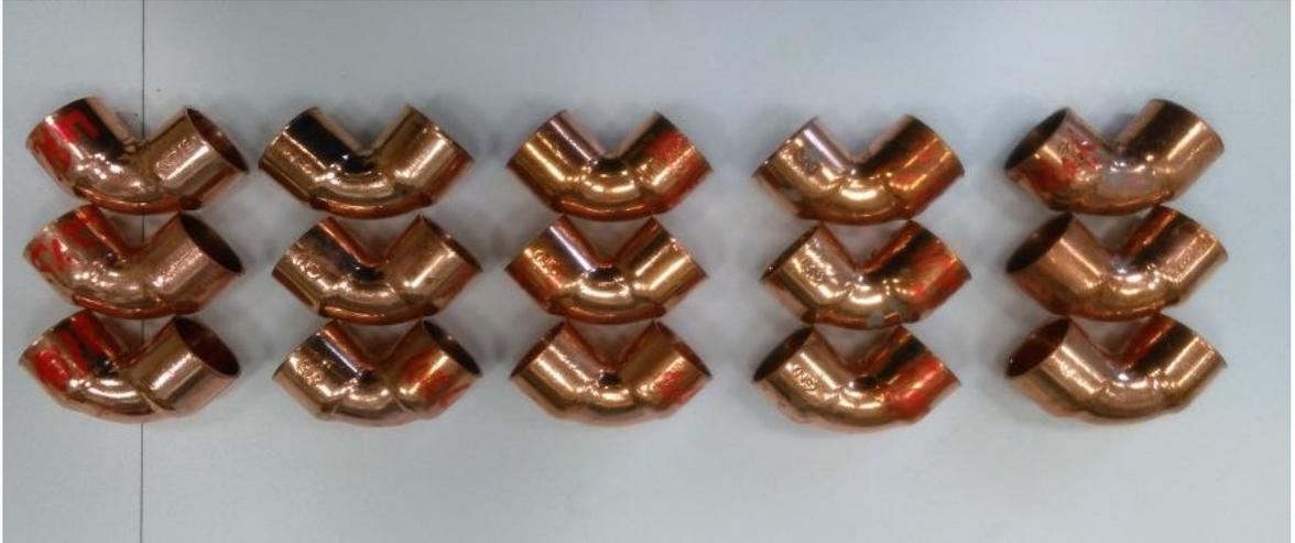
**Ilustración 24 Piezas selección del inhibidor**
