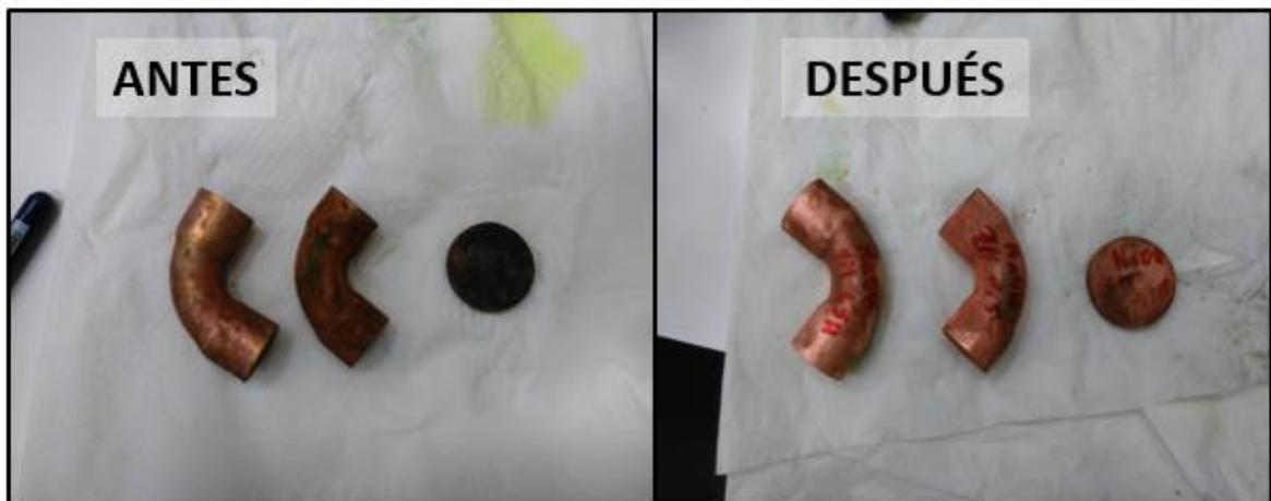
**Ilustración 21 Antes vs despues 1.5horas en NaOH**
