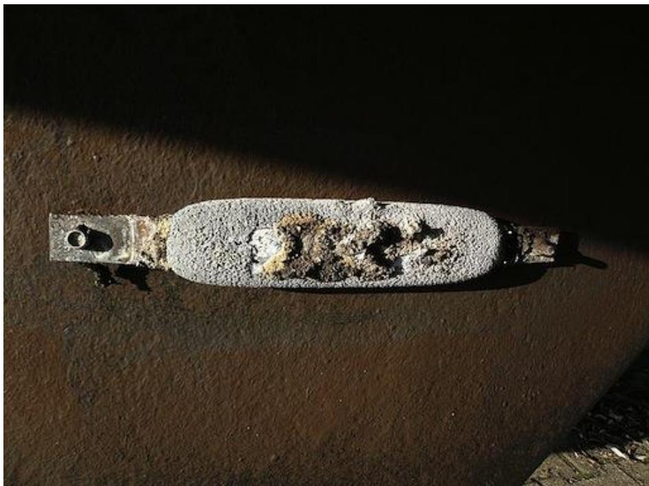
**Ilustración 11** Ánodo galvánico en la obra de un barco [13]
