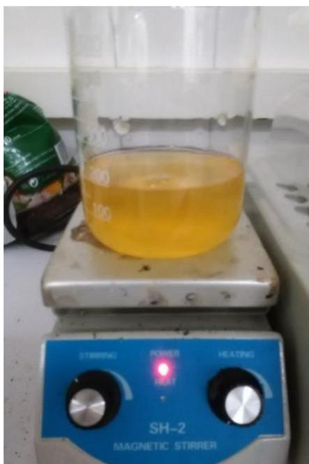
**Ilustración 29** Disolución Quitosan en HCl 0.005M
