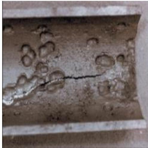
**Ilustración 7 Corrosión en medio ácido [6]**
