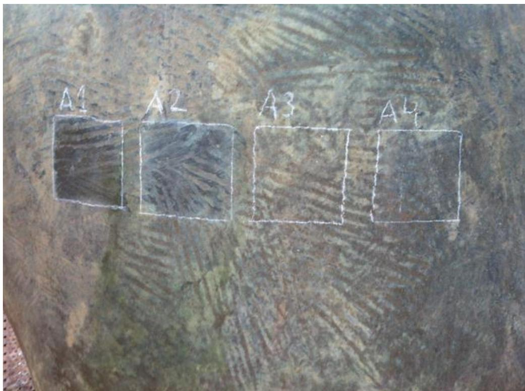
**Ilustración 14. Selección del inhibidor A1- Carbonato de sodio A2- Benzotriazol 3% A3 - Tartrato sódico-potásico 25% A4- Citrato de amonio + Benzotriazol 3% [24]**
