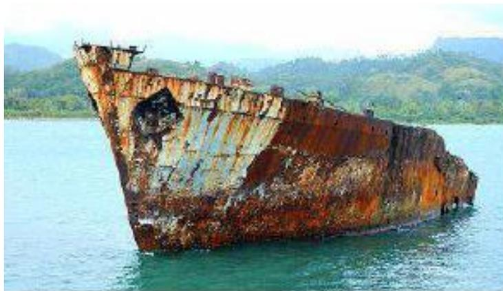
**Ilustración 5 Embarcación corrosión ambiental [6]**
