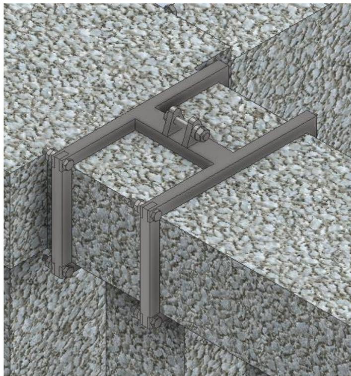
**Figura 3.8 Detalle de sujeción a la balaustrada**
