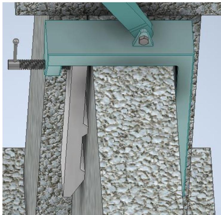
**Figura 3.6 Detalle sujeción a la pared**
