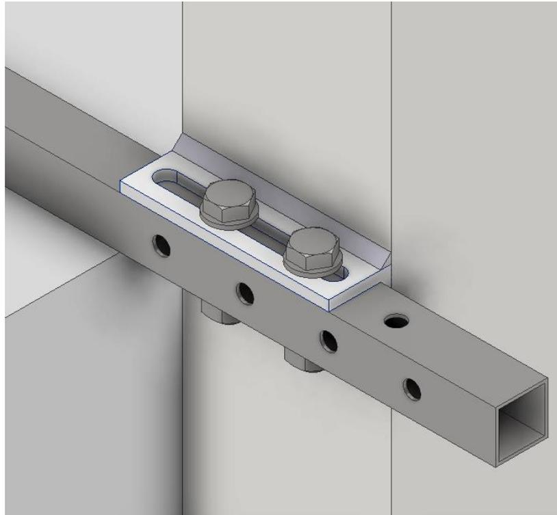
**Figura 3.21** Detalle de unión entre brazo y barra inferior
