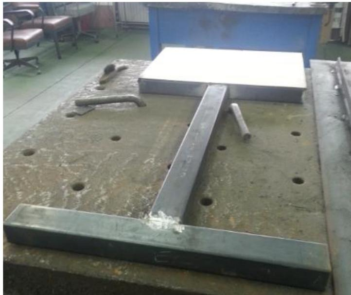
**Ilustración 6-1: Base fabricada en el taller mecánico de la ENM**
