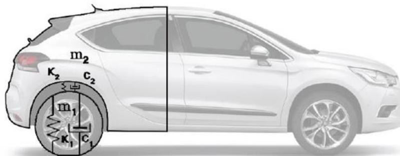
Figura 2-3 modelo vertical un cuarto de vehículo
