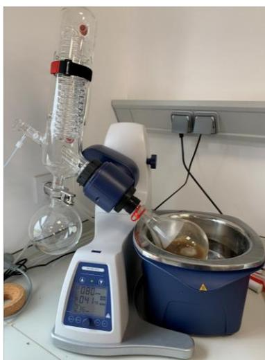
**Figura 3-18- evaporador rotativo “LBX EVA 180”**
