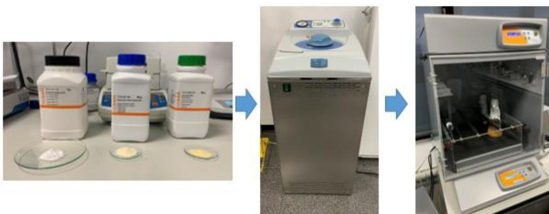
**Figura 3-14- Esquema preparación medio inóculo. Glucosa, peptona y extracto de levadura (imagen de la izquierda), autoclave “Med 20” (imagen central) e incubadora “OVAN Cienytech” con mezcla inocula (imagen de la derecha)**
