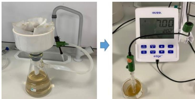
**Figura 3-8 -Montaje de filtrado por vacío (figura de la izquierda) y herramienta para medir el pH marcando 7 (figura de la derecha)**
