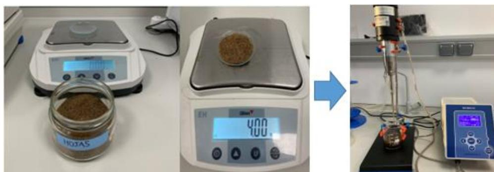
Figura 3-6- Proceso de sonicación
