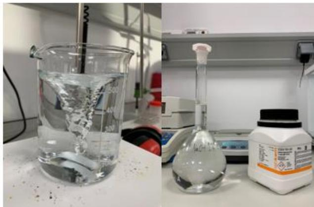
**Figura 3-4-** Vaso de precipitado con la disolución girando (figura izquierda) y disolución NaOH 1% y envase con perlas de NaOH (figura derecha)
