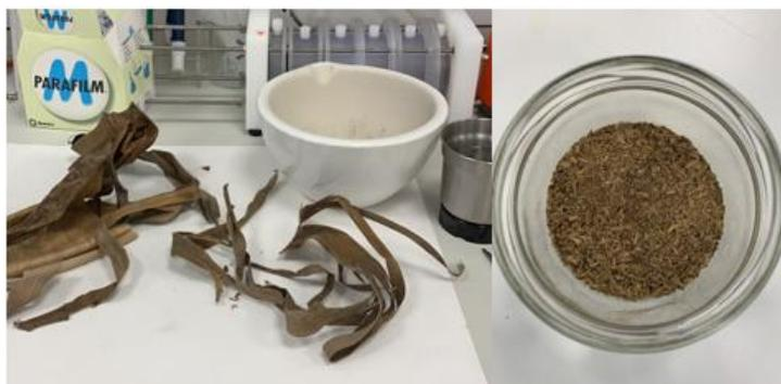
**Figura 3-3- Residuo cortado (figura de la izquierda) y residuo triturado (figura de la derecha)**
