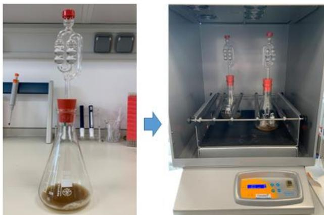
**Figura 3-15-Matraz con sistema air-lock (imagen izquierda) e incubadora con dos matraces (imagen derecha)**
