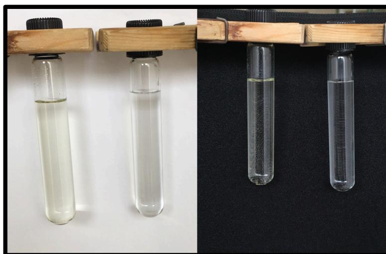
Figura 4-8 Test de turbidez y coloración
