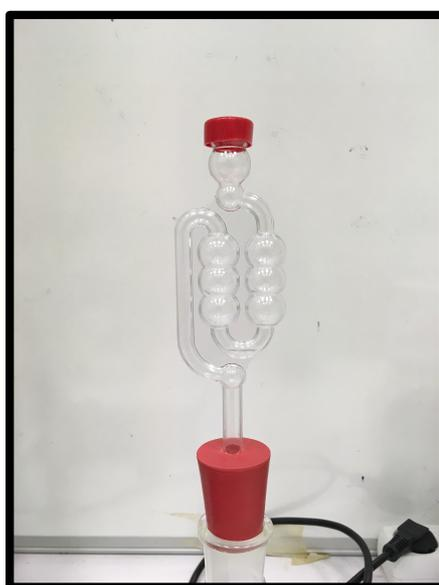
Figura 3-8 Airlock usado para fermentación
