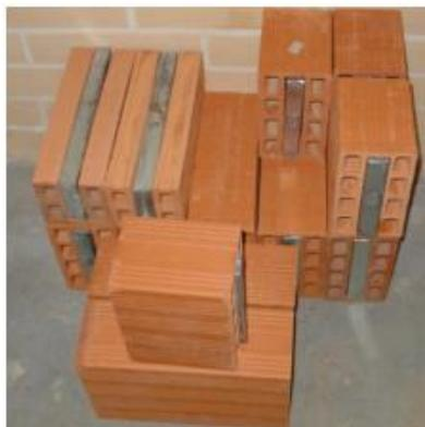
**Figura 2-8** Material de construcción con compuestos que implementan PCM incorporados.
