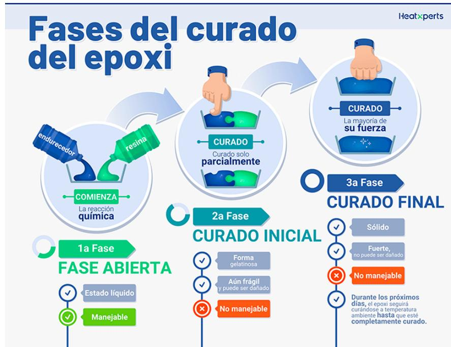
Figura 2-1 Fases del proceso de curado del material epoxi.
