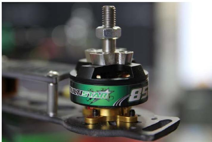
Figura 1-5 Motor Brushless montado en brazo de cuadricóptero (Fuente [3])
