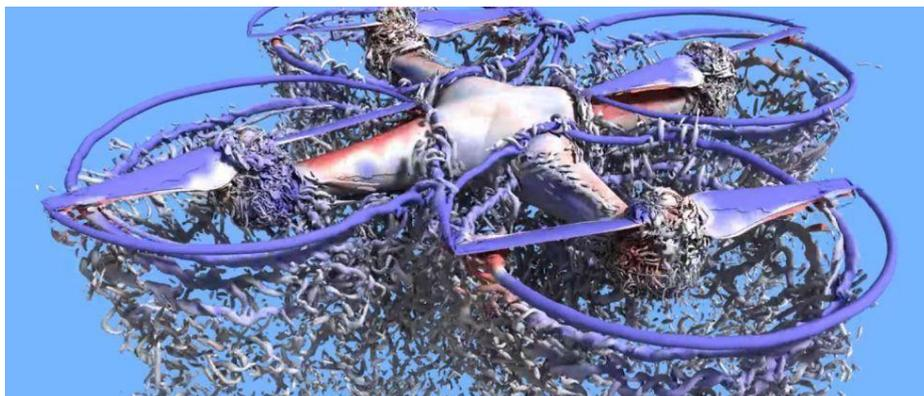
**Figura 8-3** Simulación aerodinámica del DJI Phantom 3 realizada por la NASA (Fuente [29])
