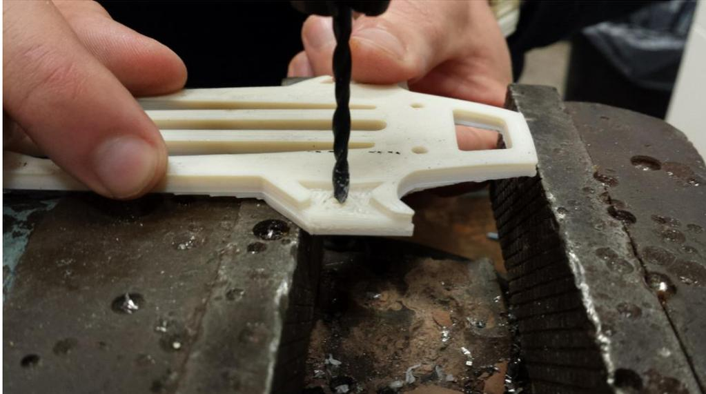
**Figura 7-6** Proceso de mecanizado de las piezas de impresión (Elaboración propia)
