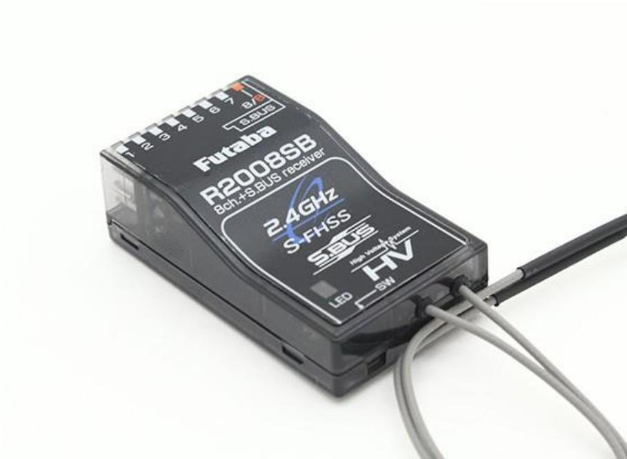
Figura 4-13 Imagen del receptor de radiocontrol escogido (Fuente [20])
