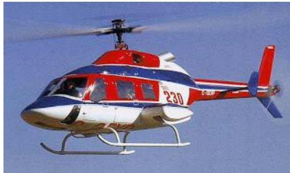
Figura 5-13 Tren de aterrizaje común en helicópteros (Fuente [24])
