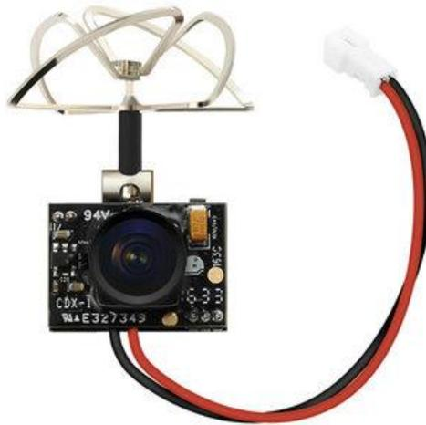
**Figura 4-10 Ejemplo de cámara con transmisor de vídeo integrado (Fuente [21])**
