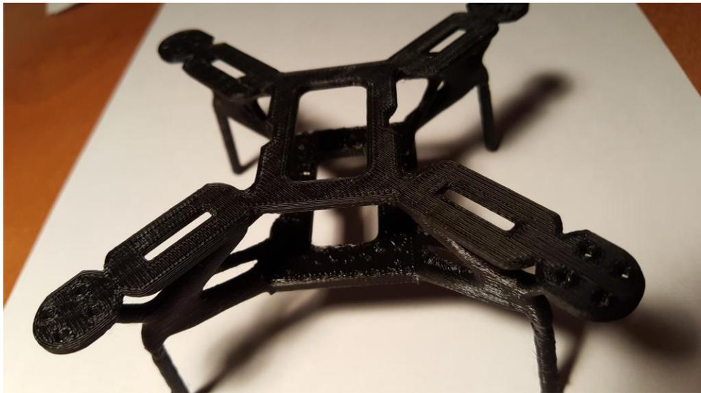
Figura 3-6 Modelo de cuadricóptero impreso en 3D (Fuente [14])
