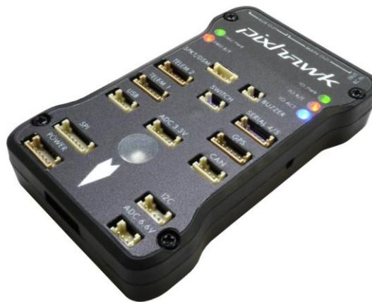
Figura 1-3 Controladora de vuelo Pixhawk (Fuente [3])
