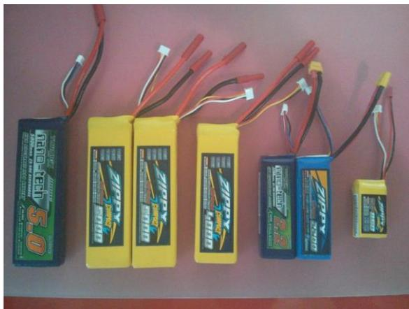
Figura 1-4 Baterías Li-Po de distintas capacidades (Fuente [3])
