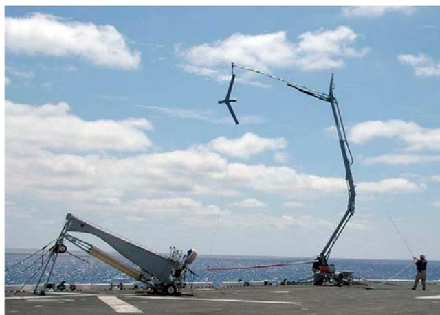
Figura 2-12 Sistema de recogida “SkyHook” (imagen tomada de [2])
