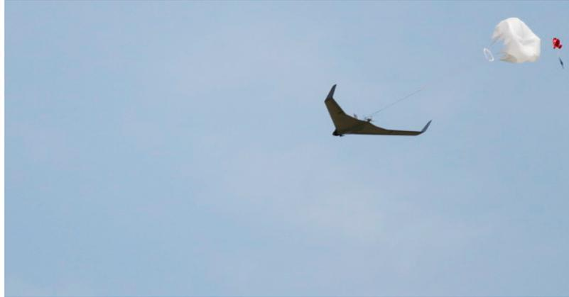
Figura 2-7 Toma con paracaídas (imagen tomada de [7])
