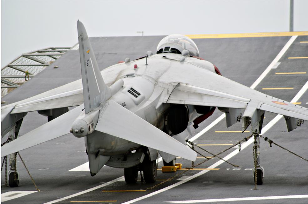
**Figura 3-4 Sistema de calzos y trincas (imagen tomada de [12])**
