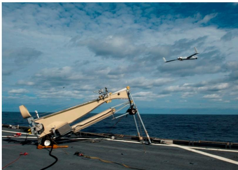
Figura 2-3 Catapulta neumática "SuperWedge" del "ScanEagle" (Imagen tomada de [4])
