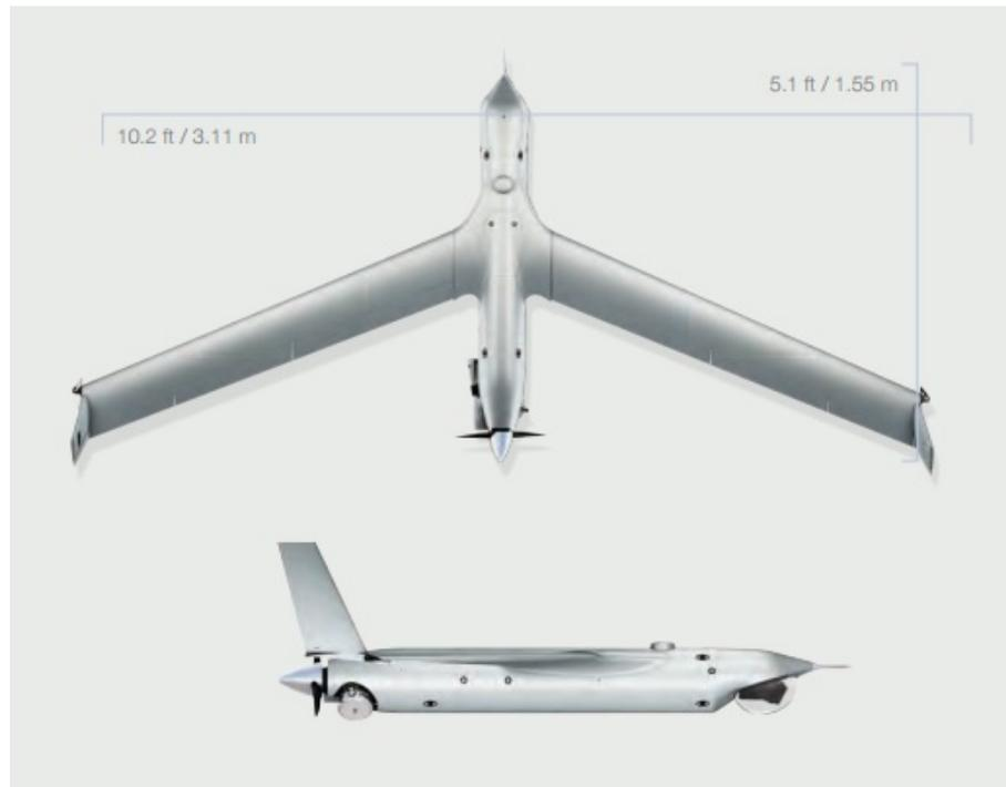
**Figura 2-13 Dimensiones del RPAS “Scaneagle” (imagen tomada de [9])**
