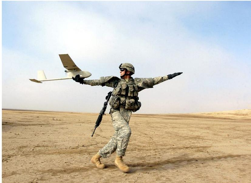
Figura 2-5 Lanzamiento manual del “Raven RQ-11” (imagen tomada de [5])
