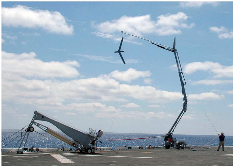
Figura 2-8 Enganche con sistema "Skyhook" para el "ScanEagle" (imagen tomada de [3])
