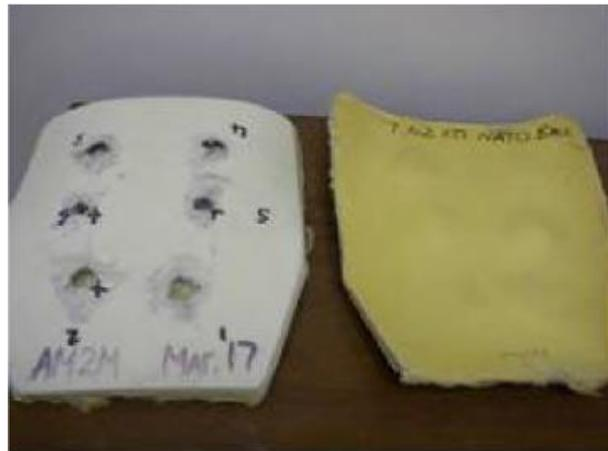
**Figura 3-4. Experimento balístico sobre placa de cerámica de alúmina-mullita con proyectiles de 7,62x51 mm disparados por una M16. Se producen seis impactos sin perforación en el material [28].**
