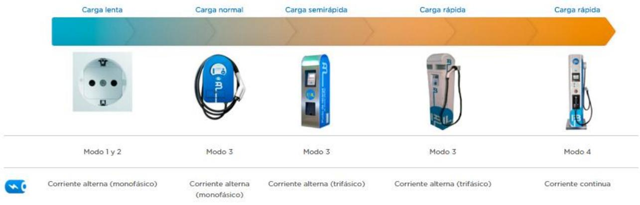
Figura 2-26 Modos de carga según standard IEC 61851 [26]
