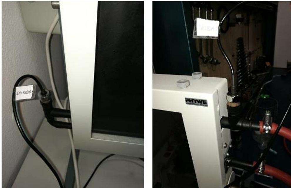
**Figura 3-14** Sondas de temperatura introducidas a la entrada y salida del colector
