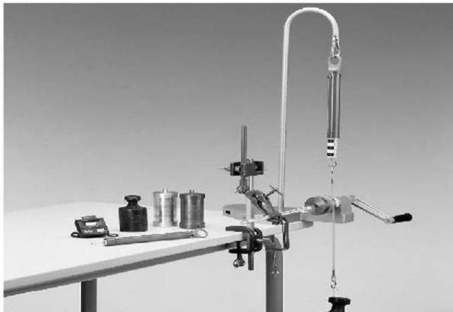
**Figura 2-1 Montaje ensayo fricción**
