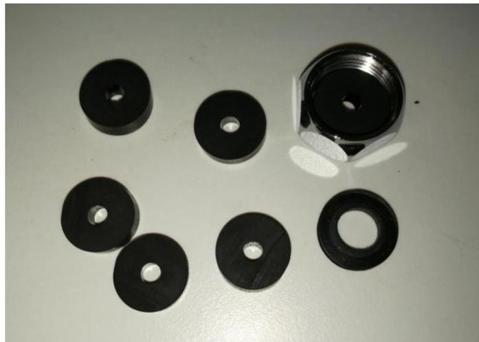
**Figura 3-15** Pasadores originales y pasador con la dimensión de la sonda
