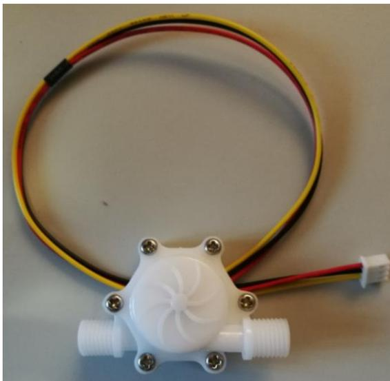
**Figura 3-2 Caudalímetro empleado**
