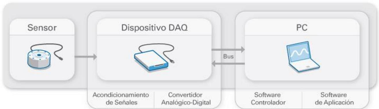
Figura 2-6 Partes de un sistema DAQ [3]
