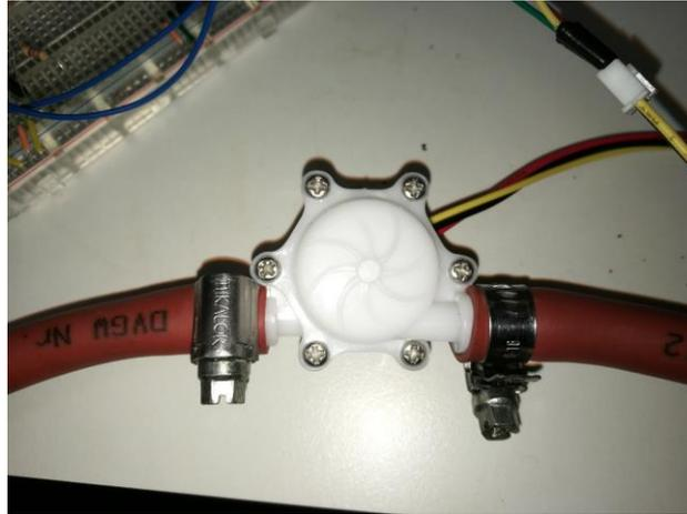
**Figura 3-16 Conexión del caudalímetro a la tubería de entrada del colector**
