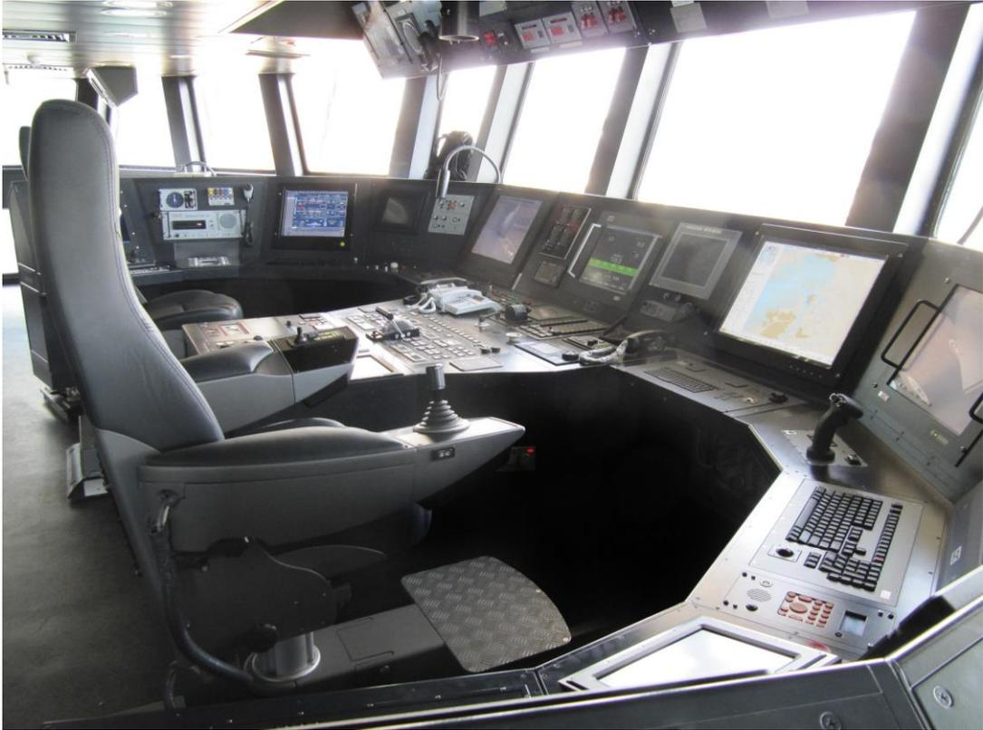
**Figura 3-13 Consolas SAINSEL distribuidas en distintos módulos. Fuente: [29]**
